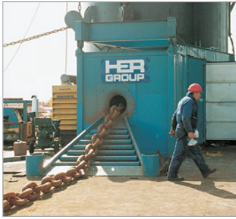
Eine PE4004S-Pumpe und ein RD3006-Zylinder beim Einsatz in einer Spezialpresse zur Reparatur defekter Kettenglieder in der Schiffbauindustrie.
