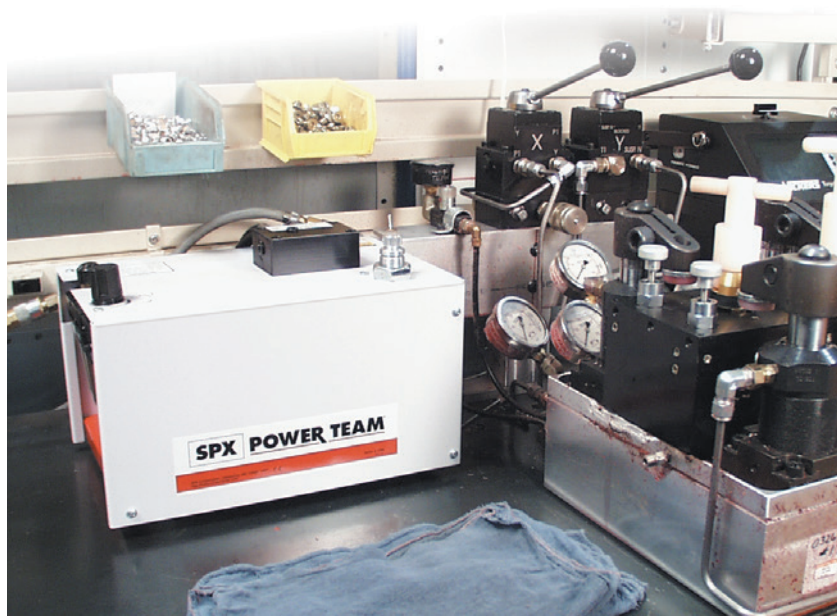
Die PA60-Pumpe beim Einsatz in einer Spannvorrichtung.
