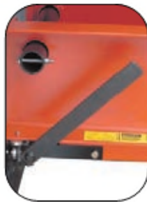
杠杆放下，床身用 以压接，提起用以 转动
