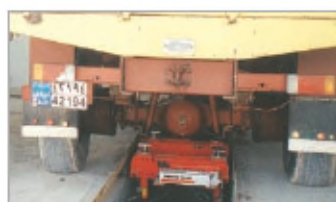
P300手动泵和10吨油缸用于汽车顶升
