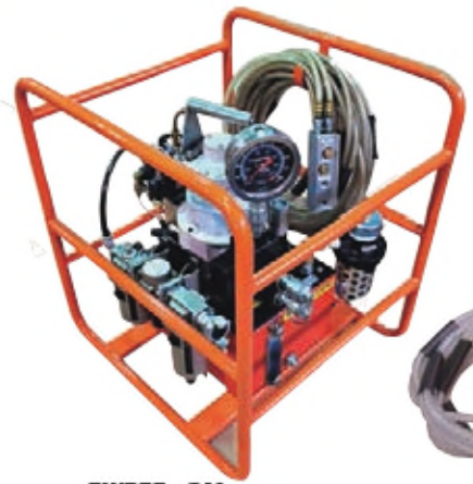
RWP55-CN (上图所示的泵包含了空气过滤器、调节阀、润滑油、排气消音器及防护边框等可选配件。)
