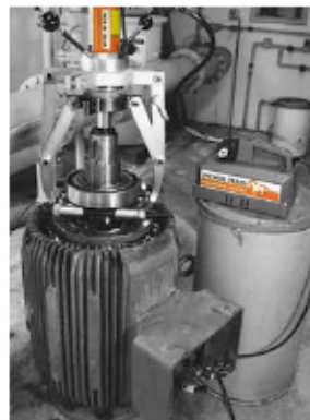
上图所示为SGH153CR拉马加配一个轴承拉拔附件，用以从一个深井泵电机上取出轴承。
