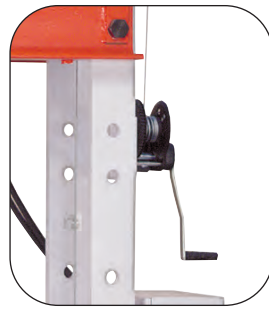
Le treuil facilite le positionnement de la table de travail
