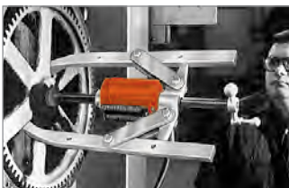
L'extracteur 2 griffes passe à travers les rayons de l'engrenage pour saisir le moyeu. La pompe manuelle fournit l'énergie hydraulique.
