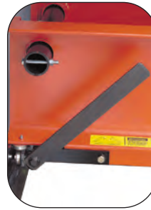
Le levier abaisse la table de travail pour les travaux de presse, la soulève pour le laminage.
