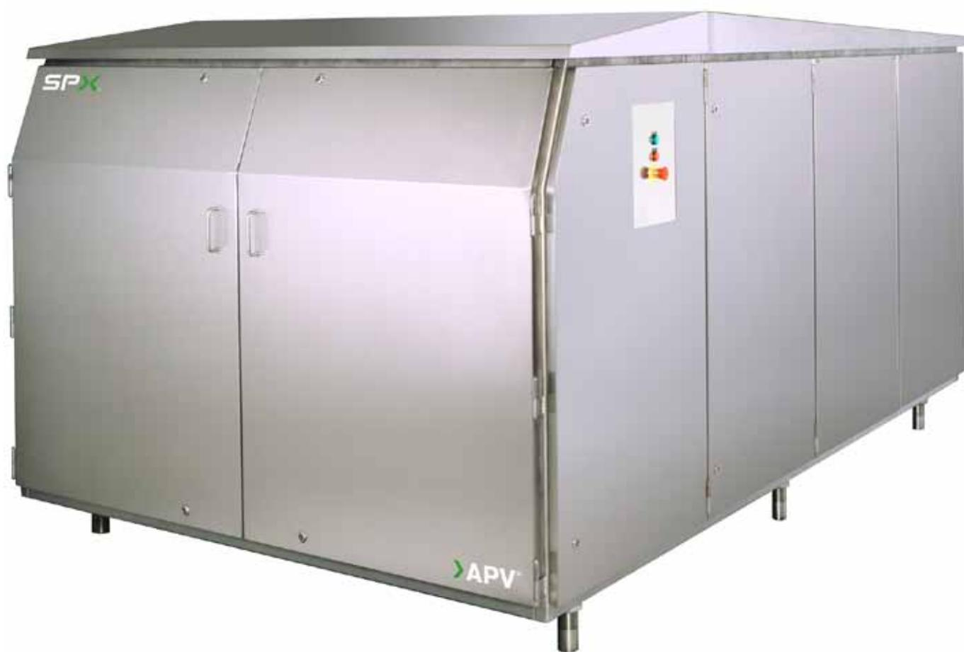
Le modèle APV 185Q est un homogénéisateur de haute performance, capable de fonctionner à des débits pouvant atteindre 50 000 litres par heure (13 209 gallons par heure) et des pressions jusqu'à 650 bars (9427,4 PSI). Il convient idéalement à vos applications d'homogénéisation.
