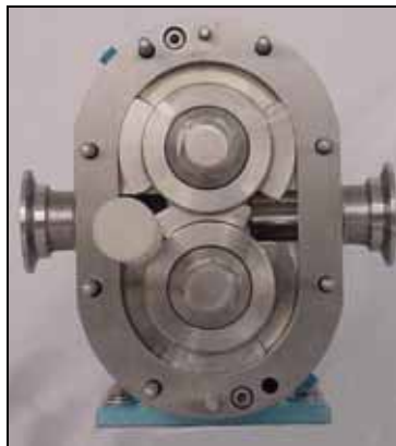
Figure 35 - Desserrage du rotor inférieur
