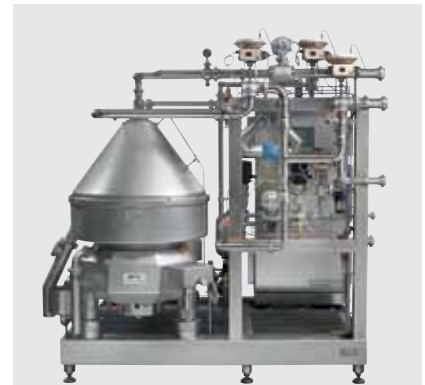
Lattiero-caseario – Scrematrice per latte con sistema automatico di titolazione latte e crema
