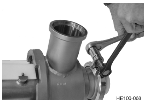
Kuva 38 - Saranoidun kiristimen asentaminen
