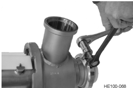
Kuva 26 - Saranoitun kiristimen poistaminen
