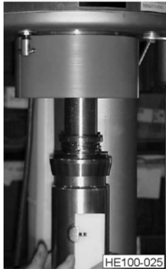
Kuva 71 - Ylemmän mekaanisen tiivisteiden ottaminen esiin
