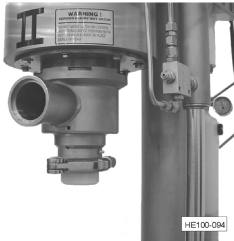
Kuva 50 - Pää uudelleen asennettuna
