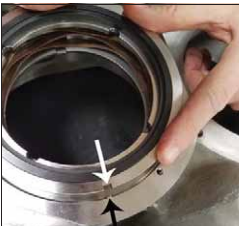
Abbildung 116 - Montage des spülseitigen Dichtungsleitlings
