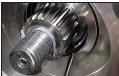
Abbildung 146 - Abnehmen des O-Rings
