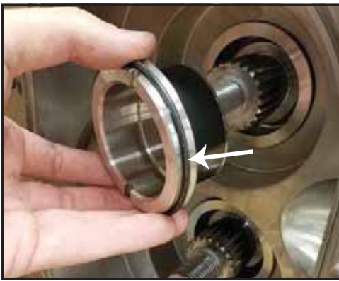
Abbildung 142 - Herausnehmen der Manschette, O-Ring
