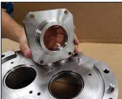
Abbildung 156 - Fluchten der Schraubenbohrungen
