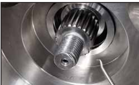
Abbildung 144 - Abnehmen des O-Rings
