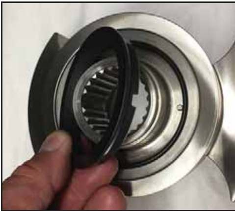
Abbildung 38 - Ausbau der Rotationsdichtung
