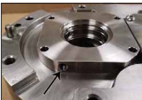
Abbildung 157 - Lage der Spülbohrung
