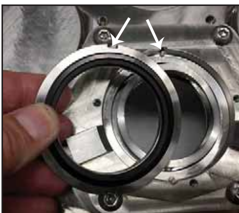
Abbildung 94 - Montage des spülseitigen Dichtungsleittrings
