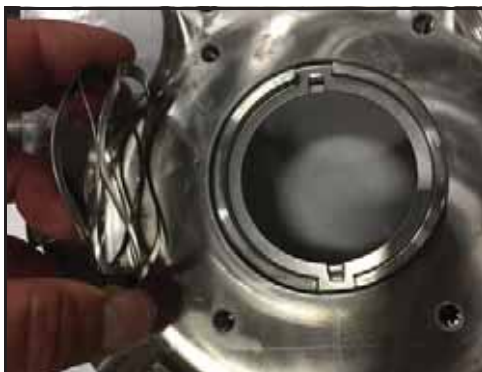
Abbildung 55 - Montage der Wellenfeder
