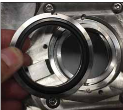
Abbildung 71 - Abnehmen des Leitrings
