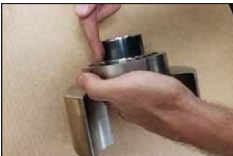
Abbildung 174 - Schmieren der Dichtungsmanschette
