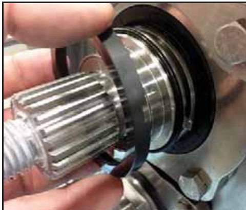
Abbildung 66 - Ausbau der spülseitigen Rotationsdichtung.
