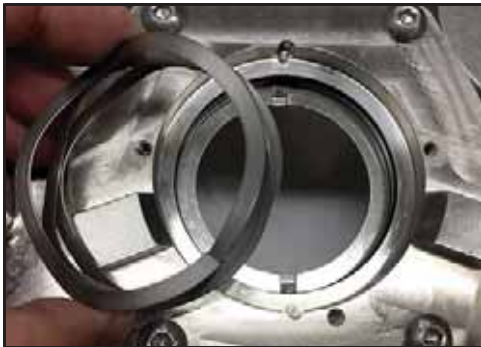
Abbildung 92 - Montage der Wellenfeder
