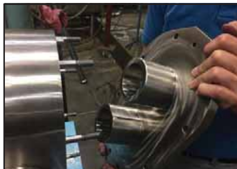
Abbildung 33 - Abnehmen des Deckels
