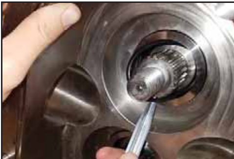
Abbildung 143 - Abnehmen des O-Rings
