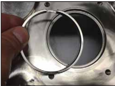
Abbildung 79 - Abnehmen des Wellenrings.
