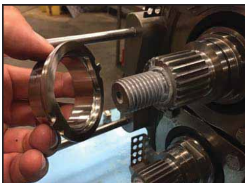
Abbildung 68 - Abnehmen des Einstellrings
