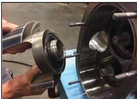
Abbildung 177 - Den Rotor auf die Welle drücken
