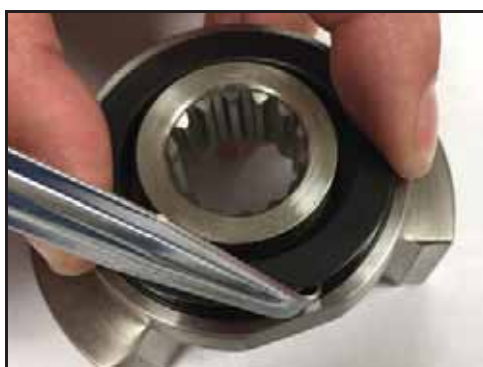
Abbildung 140 - Eindrücken des O-Rings
