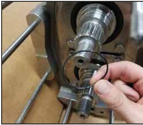
Abbildung 160 - Schmieren und montieren Sie den O-Ring
