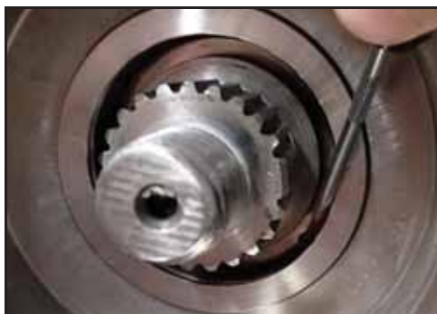
Abbildung 145 - Abnehmen des O-Rings
