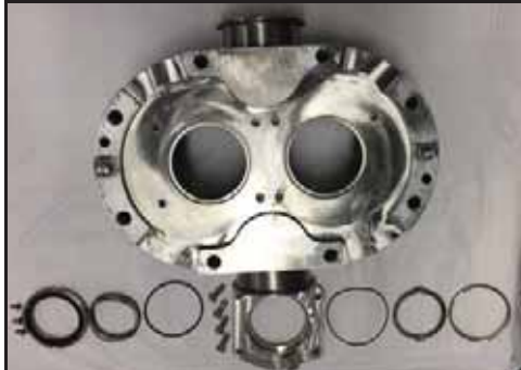
Abbildung 80 - Doppelt wirkende Gleitringdichtung (abgebildet ist 040-U3)
