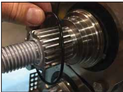
Abbildung 67 - Abnehmen des O-Rings
