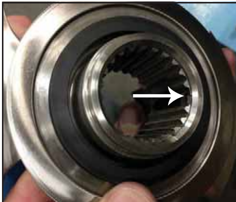
Abbildung 175 - Synchronisierungszahn auf dem Rotor.
