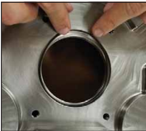
Abbildung 151 - Abnehmen des O-Rings
