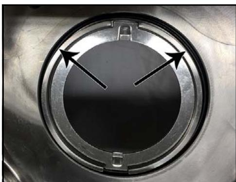
**Figura 86 - Junta tórica de la carcasa del sello instalada**
