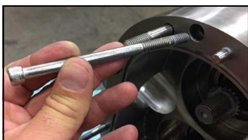
**Figura 147 - Retire los tornillos de sujeción del cuerpo**
