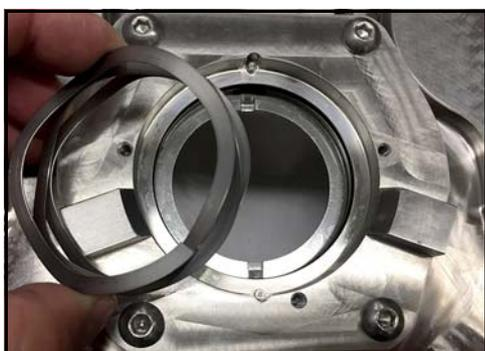
**Figura 72 - Retire el resorte de ondas**
