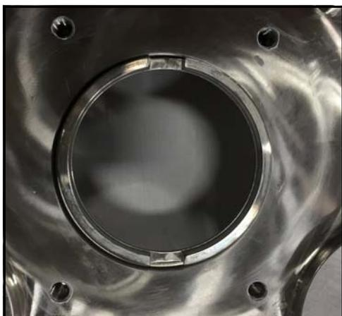
**Figura 52 - Anillo instalado**
