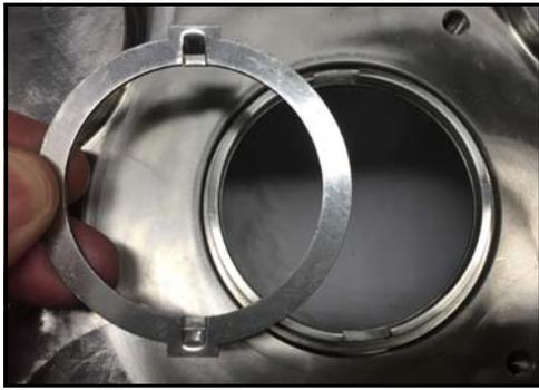
**Figura 53 - Instalar el anillo impulsor**
