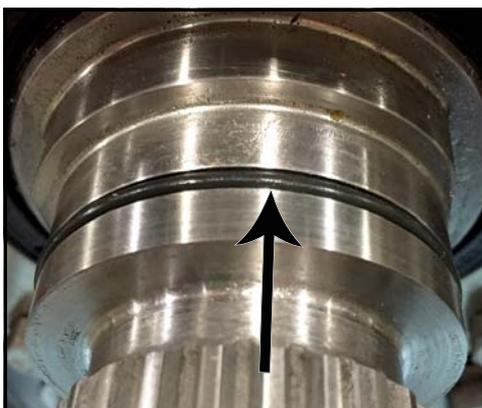
**Figura 120 - Junta tórica instalada**
