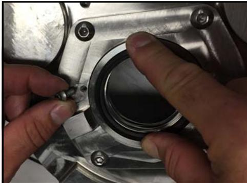
**Figura 96 - Instale los pernos de retención del sello**
