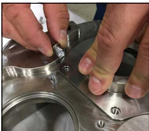
**Figura 58 - Instale los pernos de la carcasa del sello**
