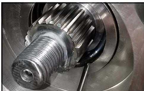
**Figura 146 - Extracción de la junta tórica**
