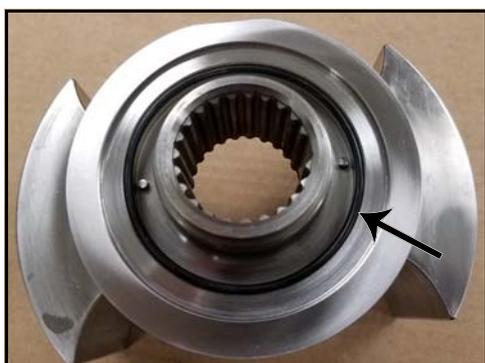
**Figura 170 - La junta tórica frontal de la manga está instalada**
