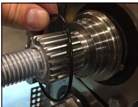
**Figura 123 - Instalar la junta tórica**
