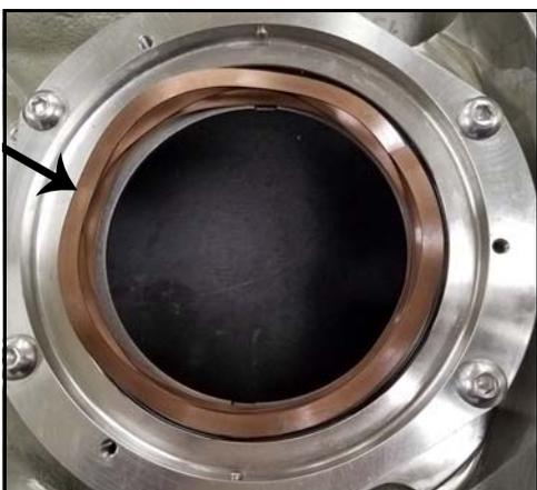
**Figura 115 - Resorte de ondas instalado**
