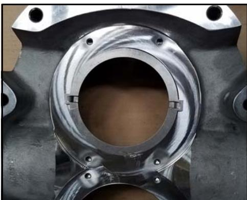
**Figura 108 - Anillo impulsor instalado**
