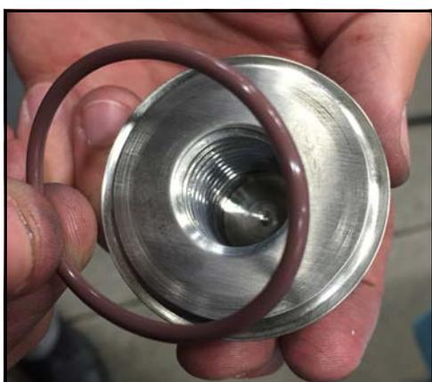
**Figura 179 - Instalar la junta tórica**
