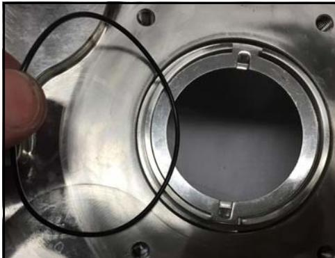
**Figura 76 - Retire la junta tórica de la carcasa del sello**
