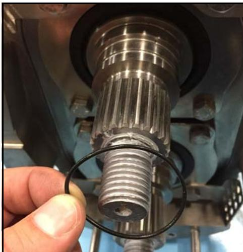
**Figura 119 - Instalar la junta tórica**
