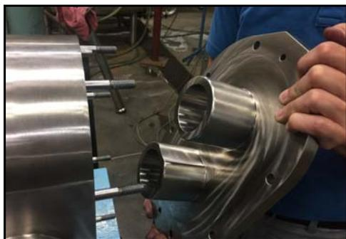
**Figura 186 - Instalar cubierta**
