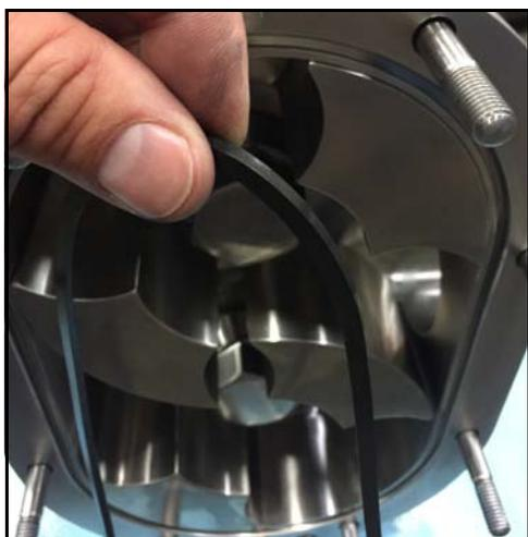
**Figura 34 - Retire la junta de la cubierta**
