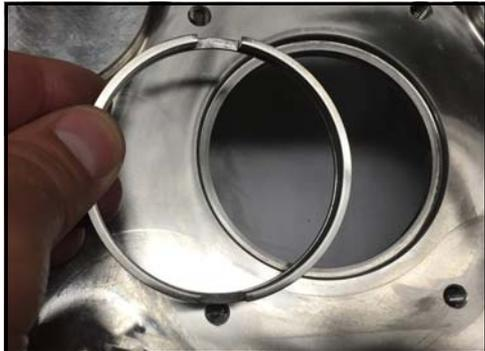
**Figura 79 - Retire el anillo del eje**
