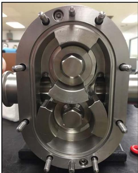
**Figura 183 - Rotores instalados**
