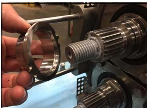
**Figura 101 - Instale anillo de ajuste**
