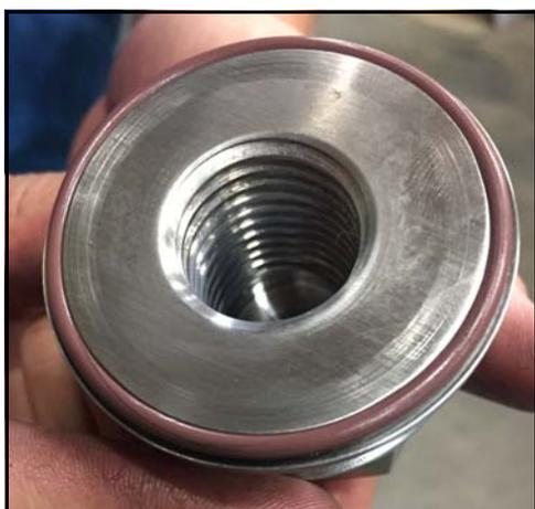
**Figura 180 - Junta tórica instalada**
