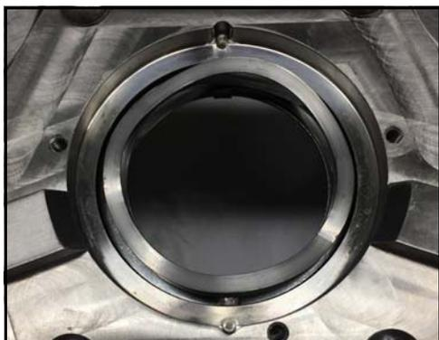
**Figura 93 - Resorte de ondas instalado**
