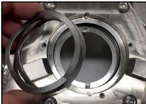
**Figura 92 - Instale el resorte de ondas**
