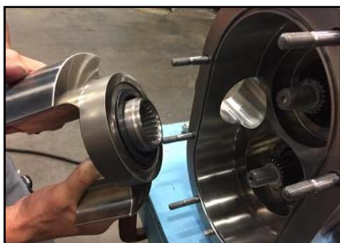
**Figura 177 - Empujar el rotor en el eje**
