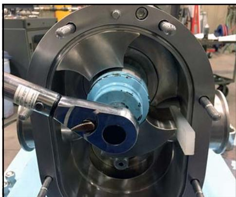
**Figura 35 - Retirar la tuerca del rotor**
