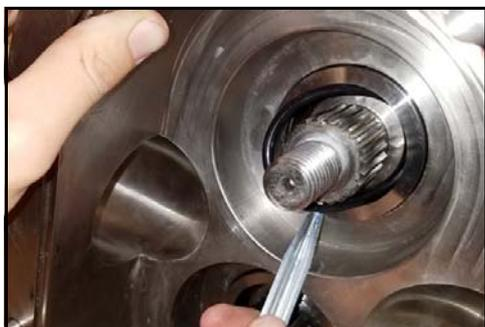
**Figura 143 - Extracción de la junta tórica**
