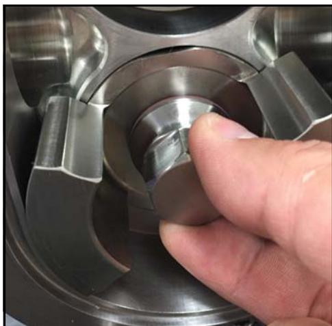
Figura 181 - Instalar tuerca de rotor
