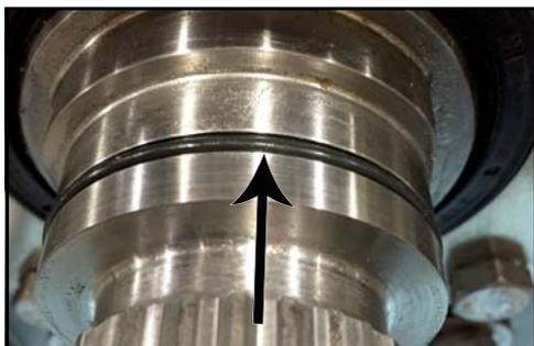
**Figura 69 - Junta tórica del anillo de ajuste**
