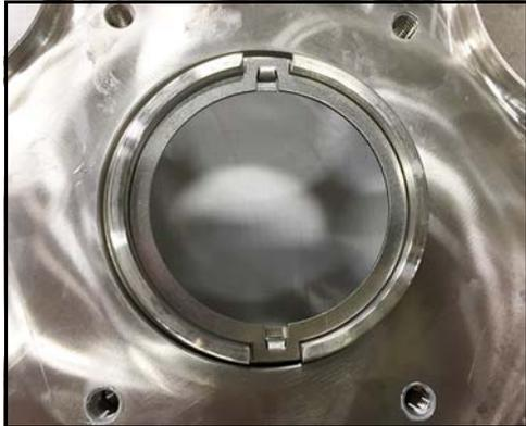
**Figura 54 - anillo impulsor instalado
