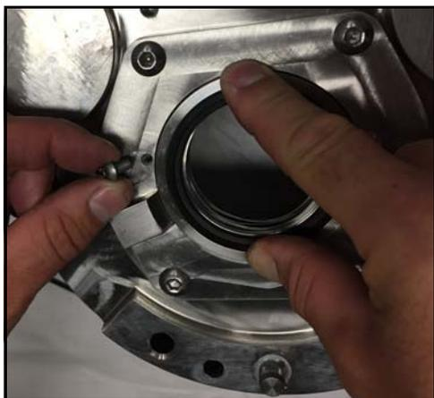
**Figura 70 - Retire los pernos de retención del sello**
