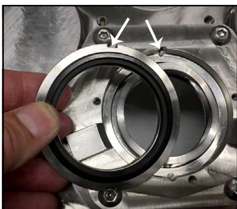
**Figura 94 - Instale el sello estacionario de descarga lateral**
