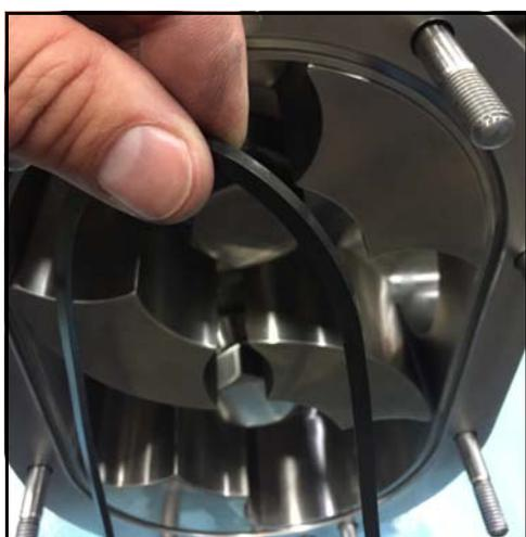
**Figura 184 - Instale la junta de la cubierta**
