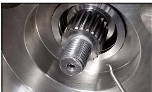
**Figura 144 - Retire la junta tórica**
