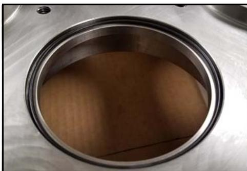
**Figura 155 - Junta tórica de la carcasa del sello instalada**
