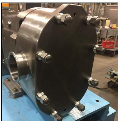
**Figura 188 - Cubierta instalada**
