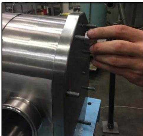
**Figura 187 - Instalar las tuercas de la cubierta**
