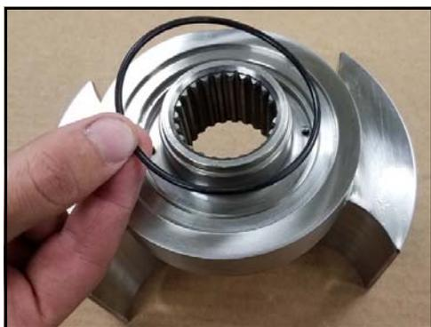
**Figura 169 - Instalar la junta tórica frontal de la manga**
