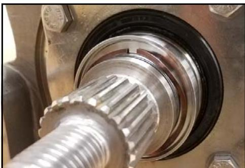
**Figura 164 - Instale el resorte de ondas**
