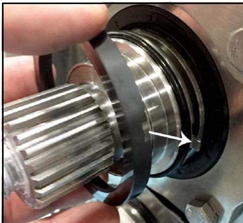
**Figura 105 - Instale el sello rotativo de descarga lateral**
