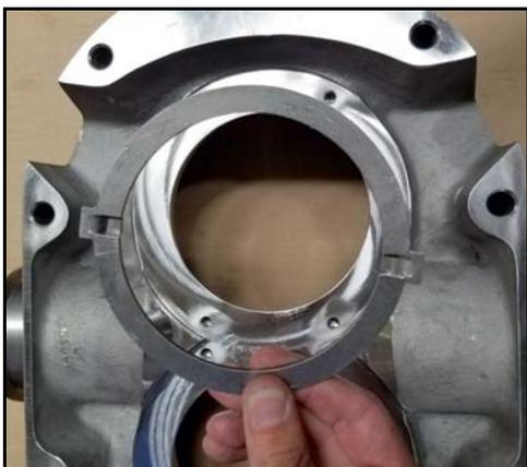
**Figura 107 - Instalar el anillo impulsor**
