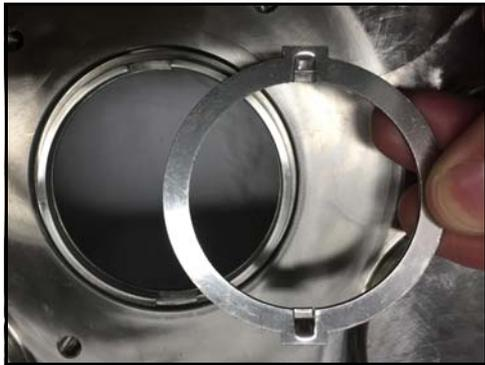
**Figura 78 - Retire el anillo impulsor**
