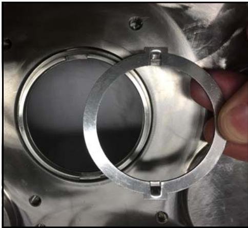
**Figura 48 - Retire el anillo impulsor**
