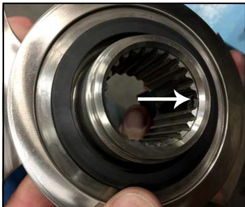
**Figura 175 - Ranura de sincronización del rotor**
