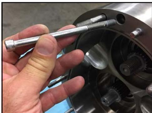
**Figura 167 - Instalar los tornillos de sujeción del cuerpo**
