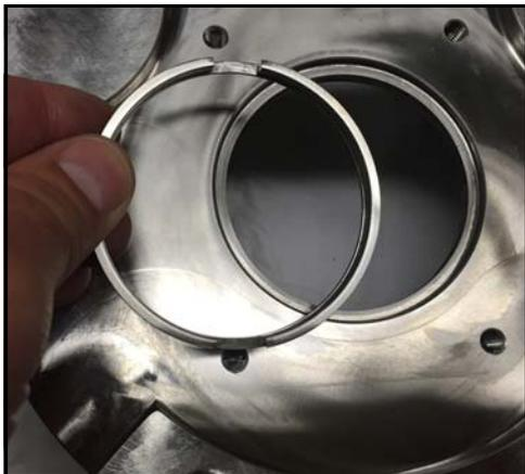
**Figura 49 - Retire el anillo del eje**
