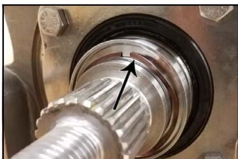
**Figura 152 - Retire el resorte de ondas del eje**
