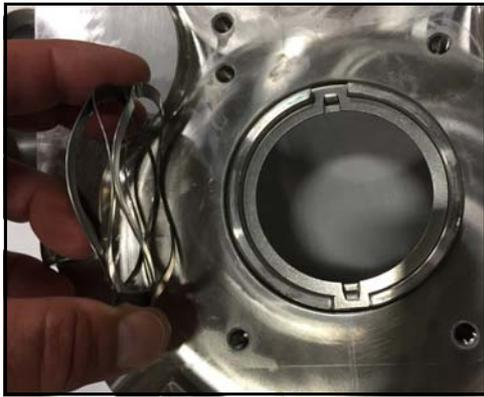
**Figura 47 - Retire el resorte de ondas**
