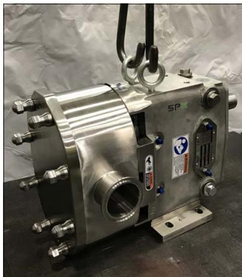
Figura 3 - Ubicación para la elevación
