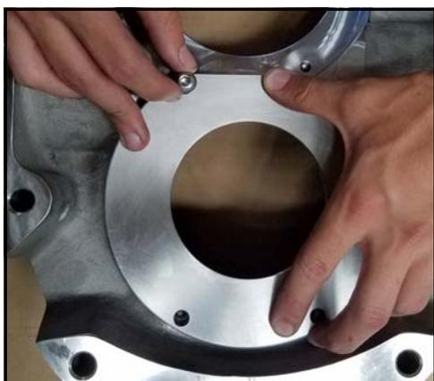
**Figura 64 - Instale los pernos de la carcasa del sello**
