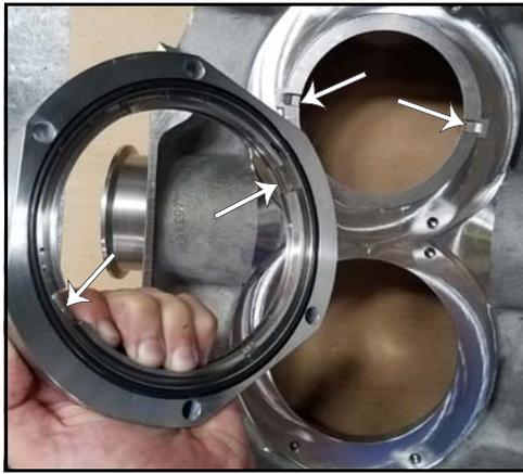
**Figura 110 - Junta tórica de la carcasa del sello instalada**
