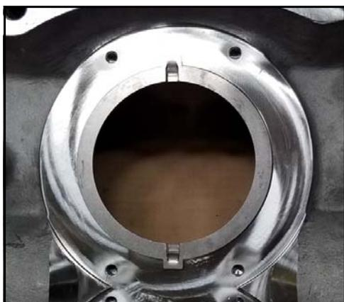
**Figura 61 - Anillo impulsor instalado**
