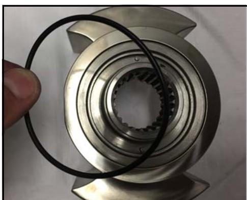
Figura 39 - Retire la junta tórica
