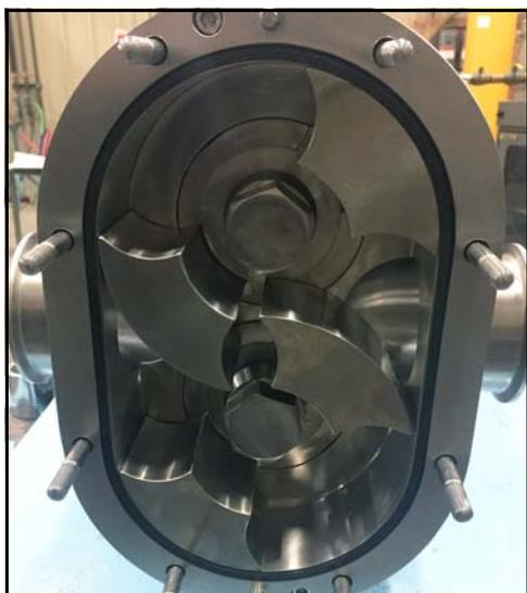
**Figura 185 - Junta de la cubierta instalada**
