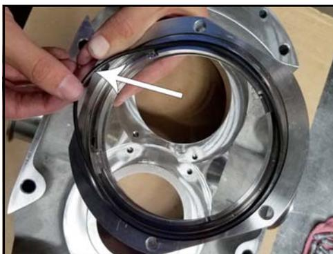
**Figura 77 - Retire la junta tórica de la carcasa del sello**
