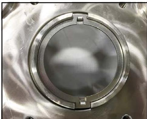
**Figura 84 - Anillo impulsor instalado**
