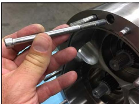
**Figura 129 - Instalar los tornillos de sujeción del cuerpo**
