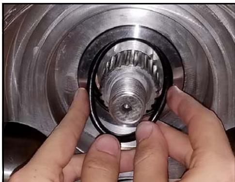
**Figura 168 - Instalar la junta tórica del sello**
