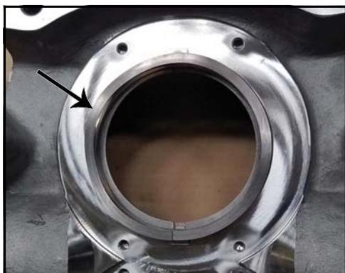
**Figura 62 - Resorte de ondas instalado**
