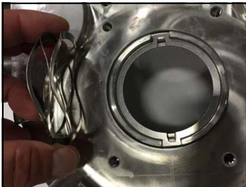
**Figura 55 - Instale el resorte de ondas**
