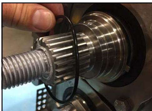
**Figura 67 - Extracción de la junta tórica**
