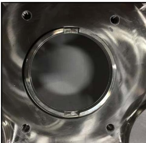
**Figura 82 - Anillo del eje instalado**
