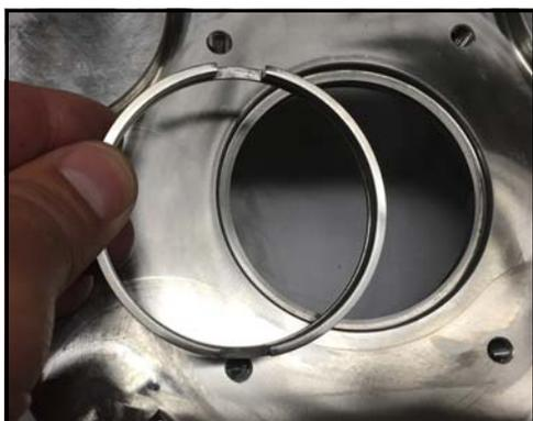
**Figura 51 - Instale el anillo del eje**
