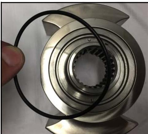
**Figura 135 - Instalar la junta tórica del sello**
