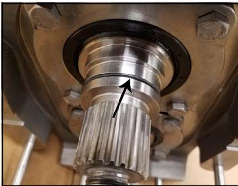
**Figura 161 - Junta tórica instalada**
