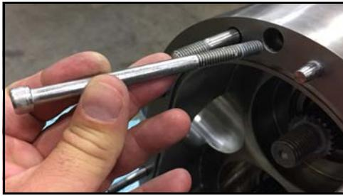
**Figura 42 - Retire los tornillos de sujeción del cuerpo**
