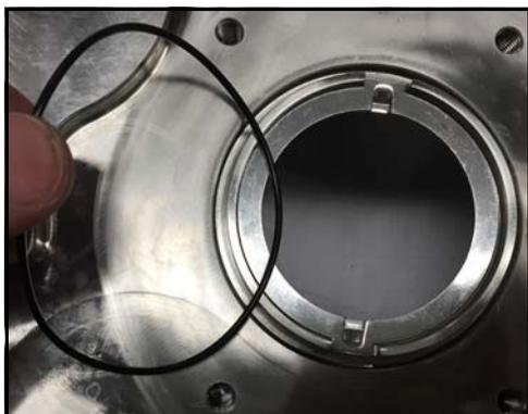
**Figura 85 - Instalar la junta tórica de la carcasa del sello**
