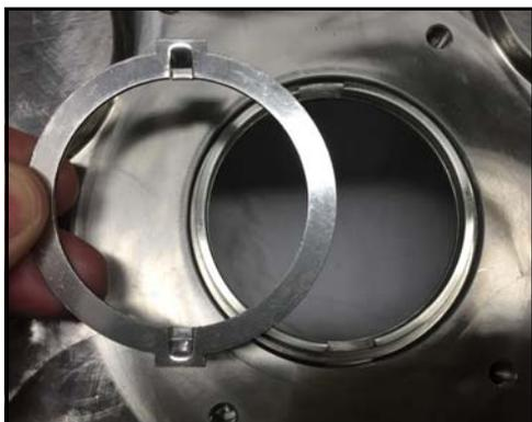
**Figura 83 - Instalar el anillo impulsor**
