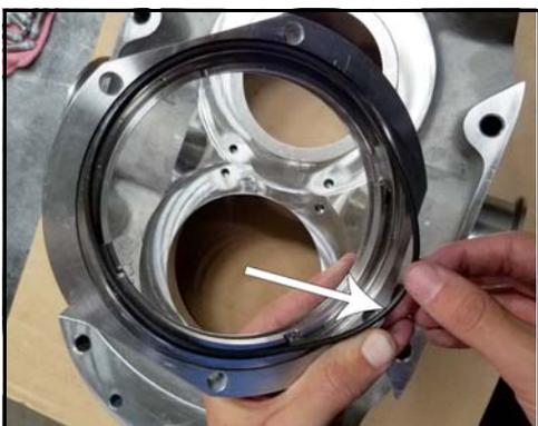
**Figura 109 - Instalar la junta tórica de la carcasa del sello**
