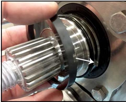
**Figura 125 - Instale el sello rotativo de descarga lateral**
