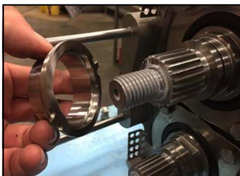
**Figura 68 - Retire el anillo de ajuste**
