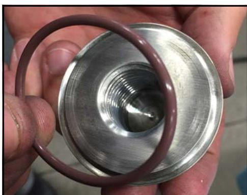
**Figura 36 - Extracción de la junta tórica**
