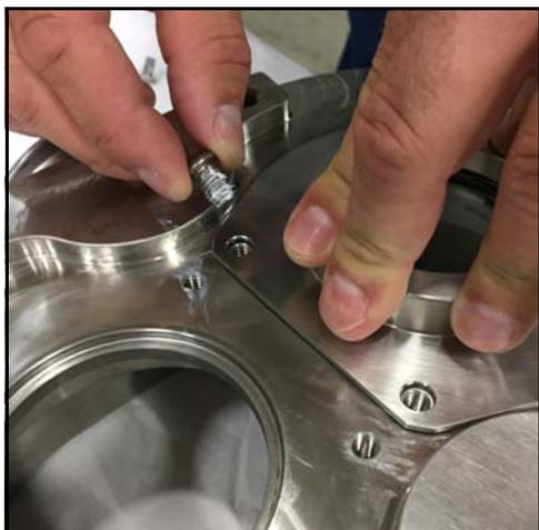
**Figura 44 - Retire los pernos de la carcasa del sello**
