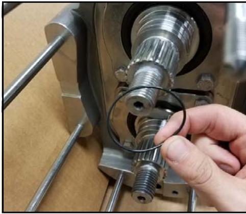
**Figura 160 - Lubricar e instalar la junta tórica**
