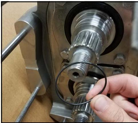
**Figura 154 - Extracción de la junta tórica**
