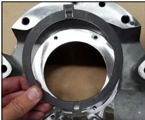
**Figura 60 - Instalar el anillo impulsor**
