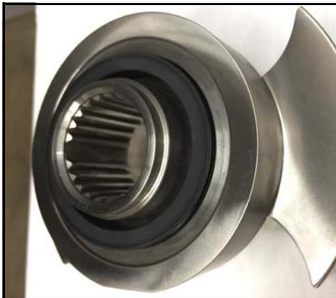
**Figura 138 - Sello rotativo instalado**
