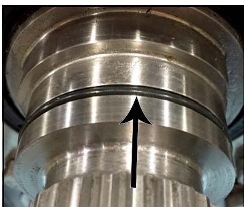
**Figura 100 - Junta tórica instalada**
