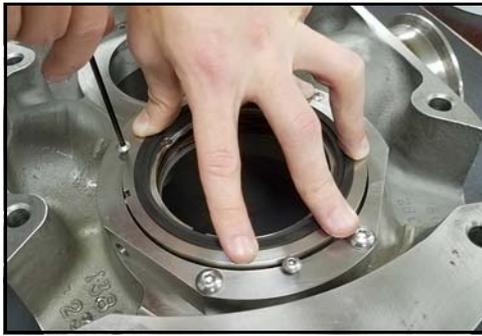
**Figura 117 - Instale los pernos de retención del sello**
