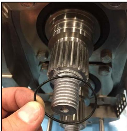
**Figura 99 - Instalar la junta tórica**
