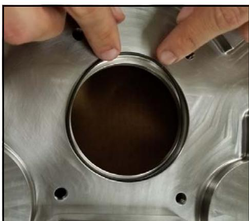
**Figura 151 - Extracción de la junta tórica**
