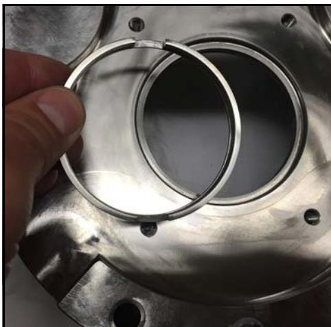
**Figura 81 - Instale el anillo del eje**
