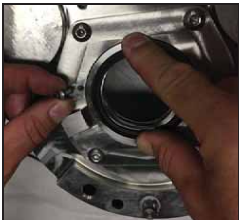
Kuva 70 - Irrota tiiviste- kiinnityspultit
