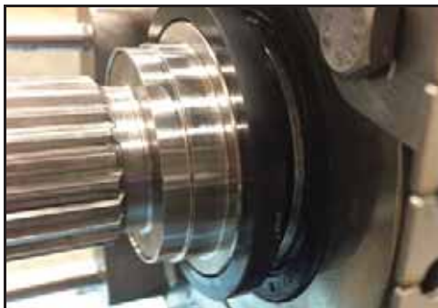
Kuva 126 - Pyörivä tiiviste asennettuna
