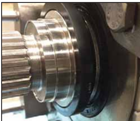
Kuva 106 - Pyörivä tiiviste asennettuna
