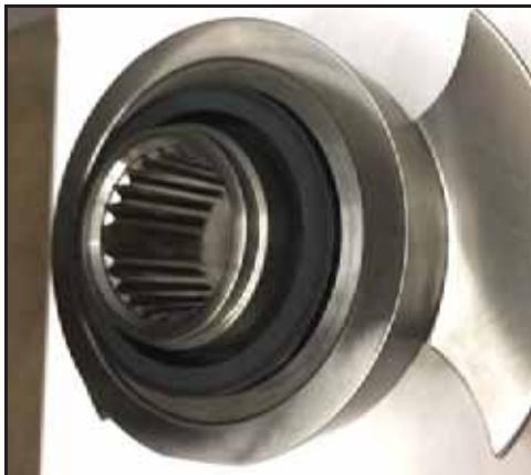
Kuva 138 - Pyörivä tiiviste asennettuna
