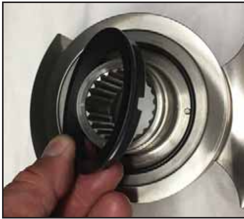
Kuva 137 - Asenna pyörivä tiiviste
