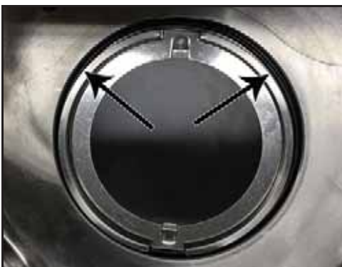
Kuva 86 - Tiivistepesän O-rengas asennettuna
