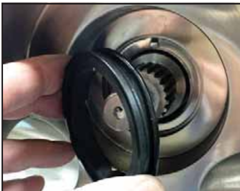
Kuva 40 - Irrota kiinteä tiiviste
