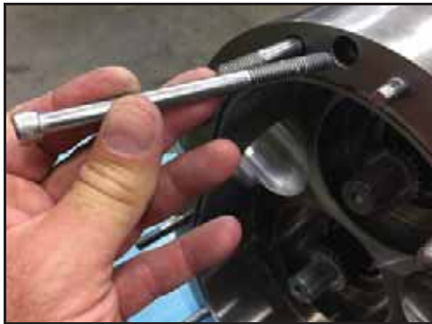
Kuva 167 - Asenna rungon kiinnitysruuvit
