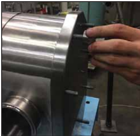
Kuva 187 - Asenna kannen mutterit
