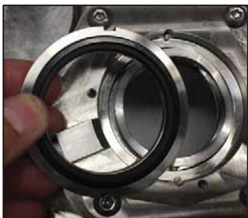
Kuva 71 - Irrota kiinteä tiiviste
