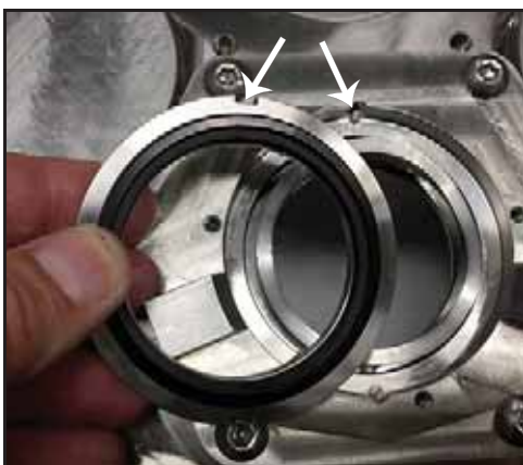
Kuva 94 - Asenna huuhtelu­puolen kiinteä tiiviste
