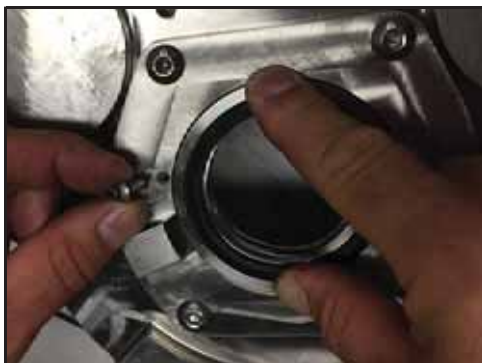
Kuva 96 - Asenna tiivisteiden kiinnityspultit
