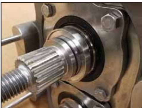
Kuva 163 - Tiivisteen istukka asennettuna
