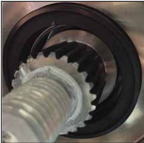
Kuva 134 - Kiinteä tiiviste asennettuna
