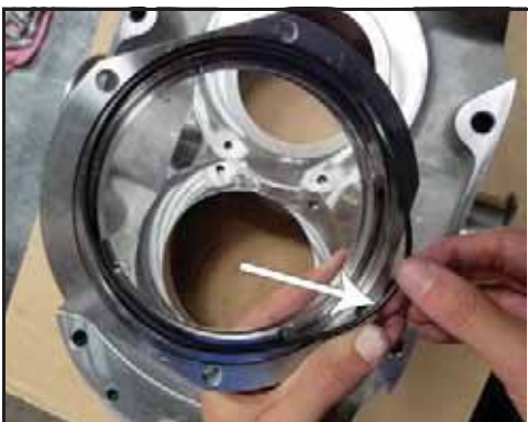
Kuva 109 - Asenna tiivistepesän O-rengas
