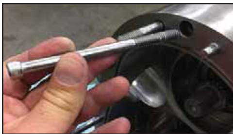
Kuva 147 - Irrota rungon kiinnitysruuvit
