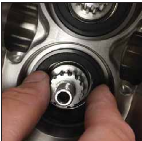
Kuva 133 - Paina kiinteää tiivistettä
