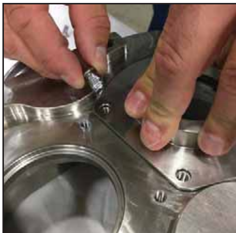
Kuva 44 - Irrota tiivistepesän pultit
