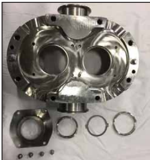
Kuva 50 - Mekaaninen yksittäistiiviste (kuvassa 040-U3)
