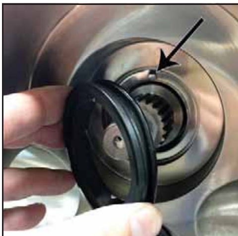
Kuva 132 - Asenna kiinteä tiiviste
