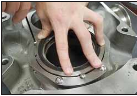
Kuva 117 - Asenna tiivisteen kiinnityspultit
