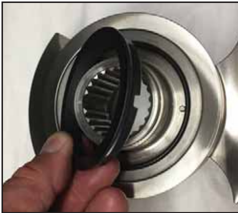
Kuva 38 - Irrota pyörivä tiiviste
