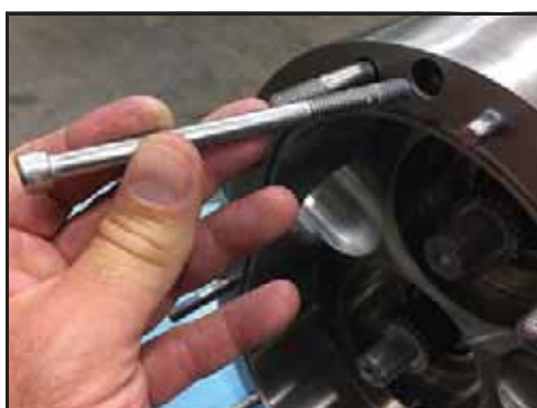
Kuva 129 - Asenna rungon kiinnitysruuvit
