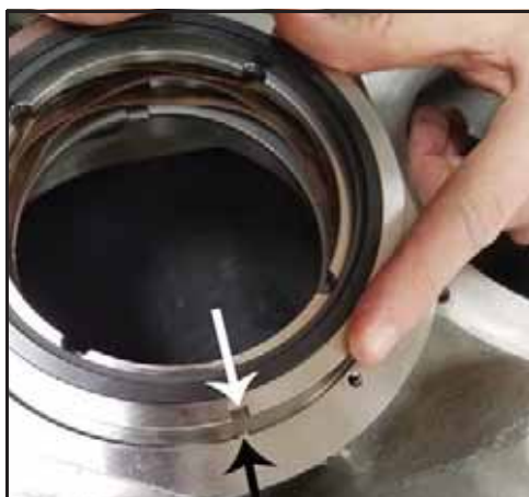
Kuva 116 - Asenna huuhtelupuolen kiinteä tiiviste
