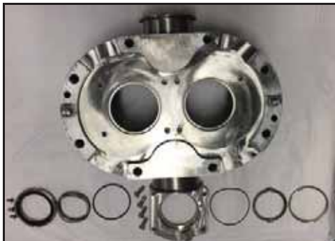
Kuva 80 - Mekaaninen kaksoistiiviste (kuvassa 040-U3)
