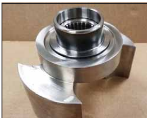
Kuva 173 - Tiivisteeseen holkki asennettuna
