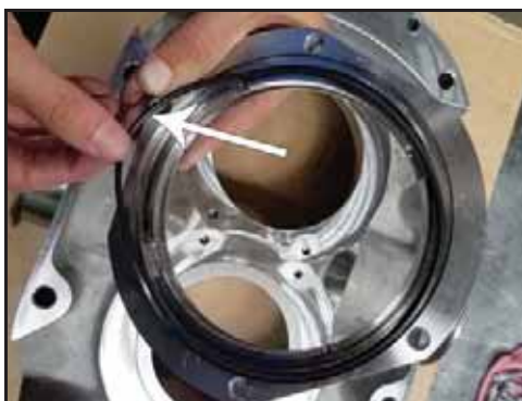
Kuva 77 - Irrota tiivistepesän O-rengas
