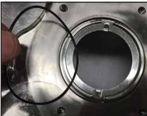
Kuva 85 - Asenna tiivistepesän O-rengas
