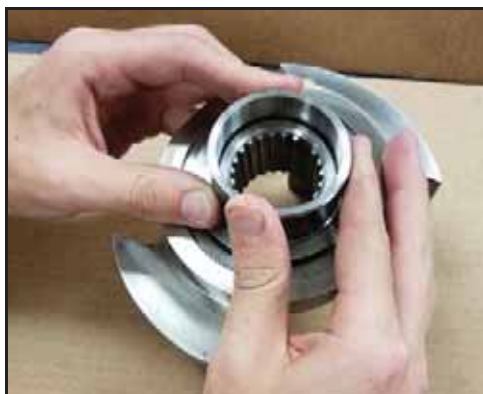
Kuva 172 - Paina holkki paikalleen
