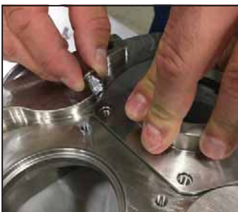
Kuva 58 - Asenna tiivistepesän pultit
