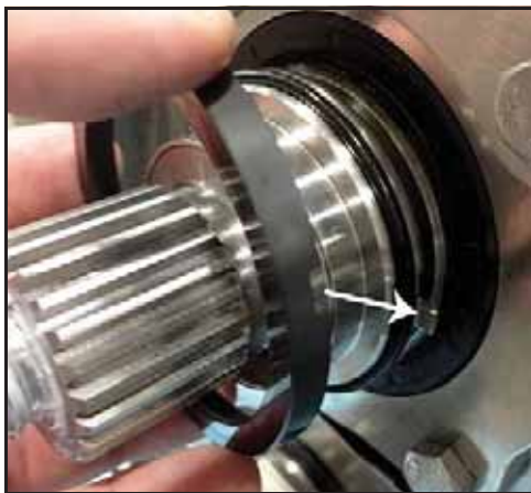
Kuva 105 - Asenna huuhtelupuolen pyörivä tiiviste
