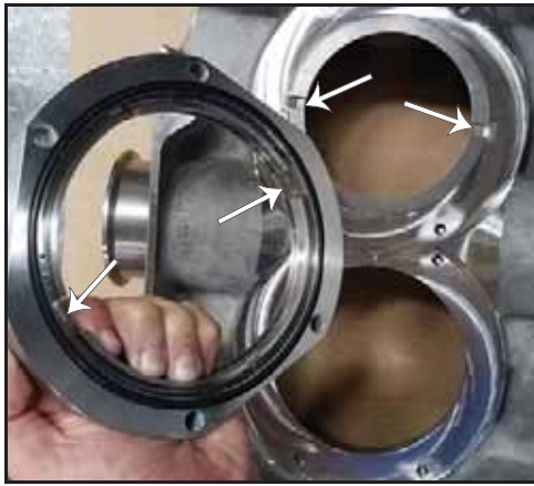
Kuva 110 - Tiivistepesän O-rengas asennettuna
