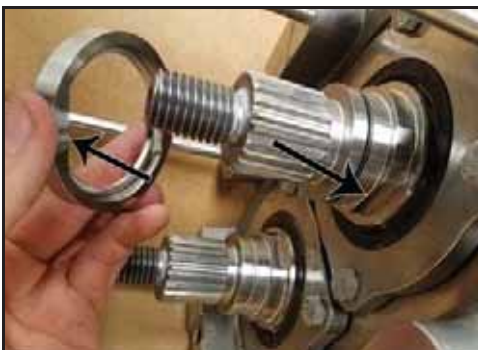
Kuva 162 - Asenna tiivisteen istukka
