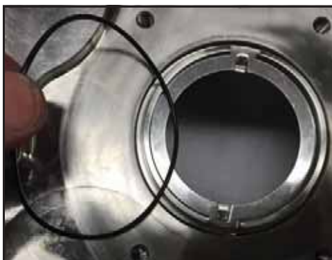
Kuva 76 - Irrota tiivistepesän O-rengas
