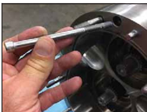
Εικόνα 129 - Τοποθετήστε τους κοχλίες συγκράτησης του σώματος
