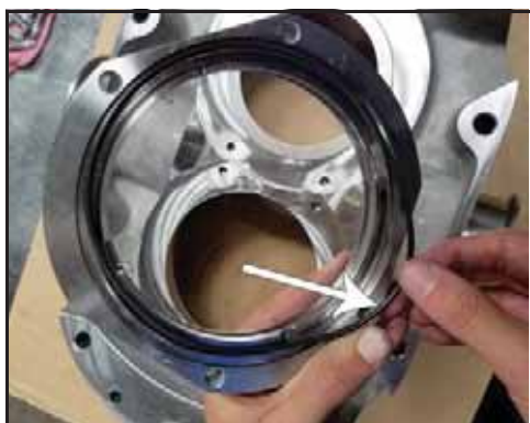
Εικόνα 109 - Τοποθέτηση δακτυλίου του περιβλήματος στεγανοποίησης
