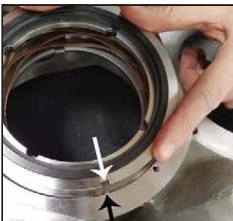
Εικόνα 116 - Τοποθέτηση στατικού παρεμβύσματος της πλευράς έκπλυσης
