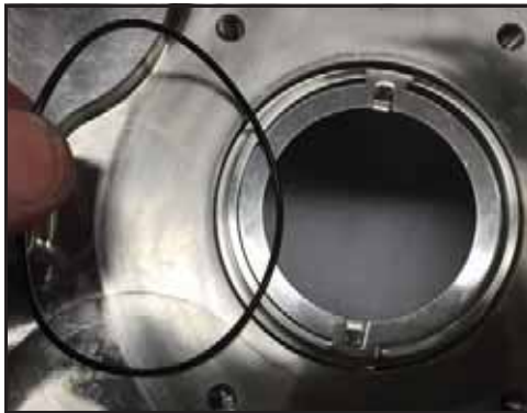
Εικόνα 76 - Αφαιρέστε τον δακτύλιο του περιβλήματος στεγανοποίησης
