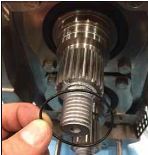
Εικόνα 119 - Τοποθετήστε τον στεγανοποιητικό δακτύλιο
