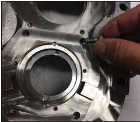
Εικόνα 88 - Μπουλόνια περιβλήματος της διάταξης στεγανοποίησης
