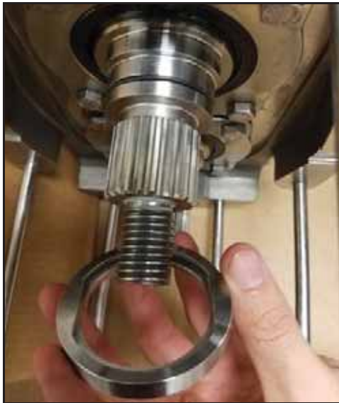
Εικόνα 153 - Αφαίρεση έδρας του παρεμβύσματος
