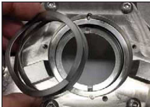
Εικόνα 92 - Τοποθέτηση ελατηριωτού παρεμβύσματος
