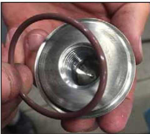
Εικόνα 179 - Τοποθετήστε τον στεγανοποιητικό δακτύλιο
