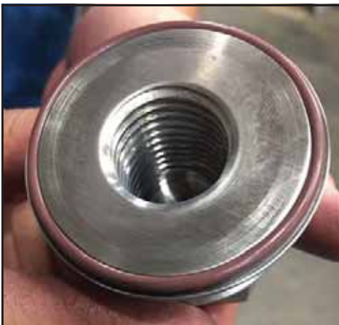
Εικόνα 180 - Τοποθετημένος στεγανοποιητικός δακτύλιος
