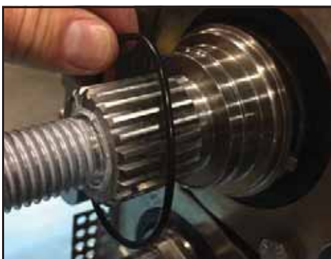
Εικόνα 123 - Τοποθετήστε τον στεγανοποιητικό δακτύλιο
