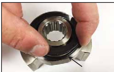
Εικόνα 139 - Στεγανοποιητικός δακτύλιος με τσάκιση
