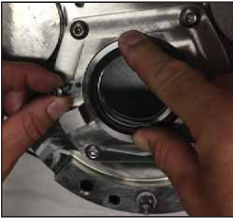
Εικόνα 70 - Αφαιρέστε τα μπουλονία συγκράτησης της στεγανοποίησης
