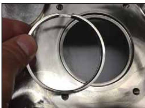
Εικόνα 79 - Αφαιρέστε τον δακτύλιο του άξονα
