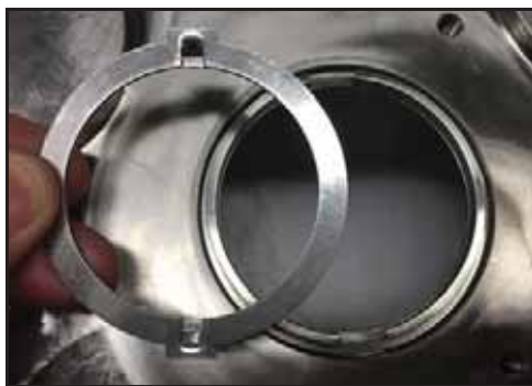
Εικόνα 53 - Τοποθετήστε τον δακτύλιο του μηχανισμού κίνησης
