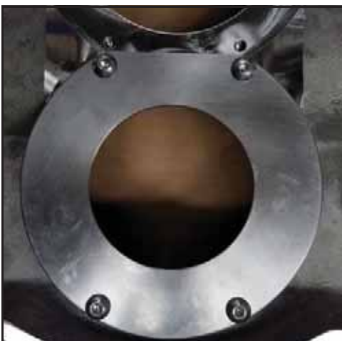
Εικόνα 65 - Τοποθετημένο περίβλημα διάταξης στεγανοποίησης
