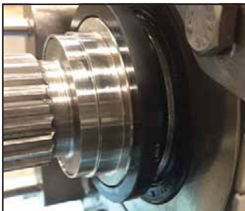
Εικόνα 106 - Τοποθετημένο περιστρεφόμενο παρεμβύσμα
