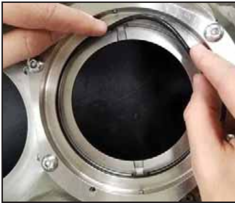
Εικόνα 113 - Τοποθετήστε τον στεγανοποιητικό δακτύλιο
