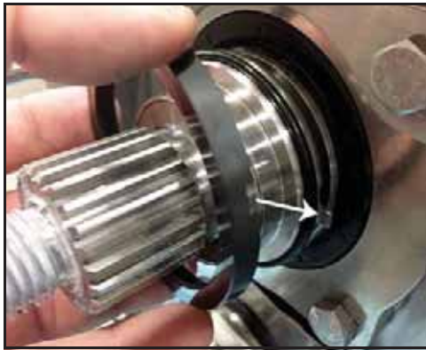
Εικόνα 125 - Τοποθέτηση περιστρεφόμενου παρεμβύσματος της πλευράς έκπλυσης
