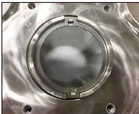
Εικόνα 54 - τοποθετημένος δακτύλιος μηχανισμού κίνησης (μοντέλα 130-U3 και μικρότερα)
