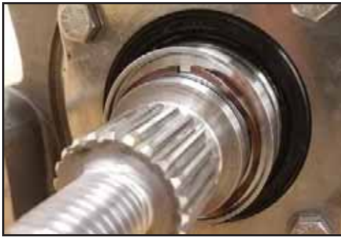
Εικόνα 164 - Τοποθέτηση ελατηριωτού παρεμβύσματος
