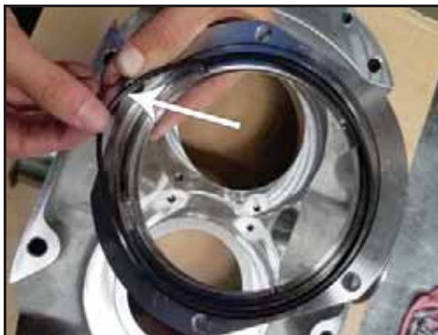
Εικόνα 77 - Αφαιρέστε τον δακτύλιο του περιβλήματος στεγανοποίησης
