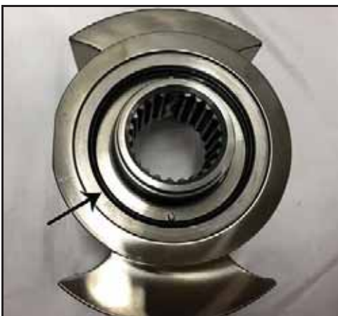
Εικόνα 136 - Τοποθετημένος στεγανοποιητικός δακτύλιος
