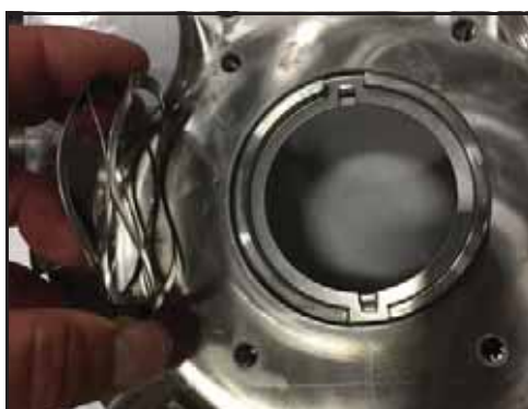
Εικόνα 55 - Τοποθέτηση ελατηριωτού παρεμβύσματος
