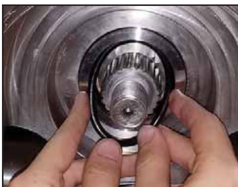
Εικόνα 168 - Τοποθετήστε τον στεγανοποιητικό δακτύλιο
