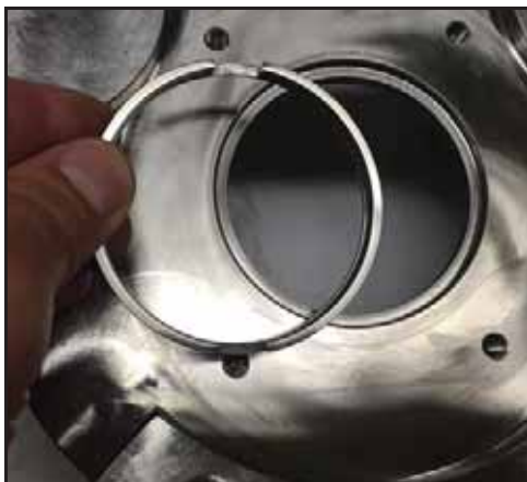
Εικόνα 49 - Αφαιρέστε τον δακτύλιο του άξονα
