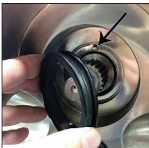
Εικόνα 132 - Τοποθέτηση στατικού παρεμβύσματος
