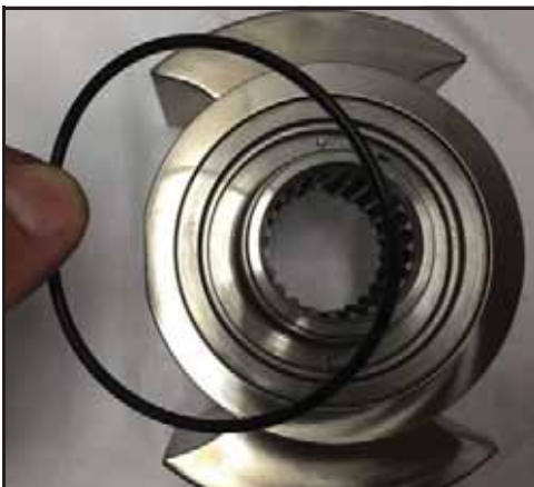
Εικόνα 135 - Τοποθετήστε τον στεγανοποιητικό δακτύλιο
