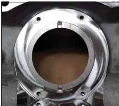
Εικόνα 61 - Τοποθετημένος δακτύλιος μηχανισμού κίνησης
