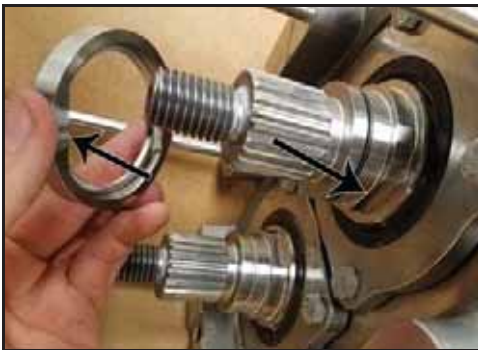
Εικόνα 162 - Τοποθετήστε την έδρα του παρεμβύσματος
