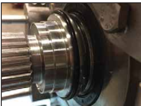
Εικόνα 124 - Τοποθετημένος στεγανοποιητικός δακτύλιος
