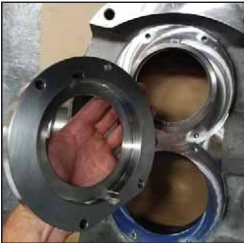
Εικόνα 63 - Τοποθετήστε το περίβλημα στεγανοποίησης
