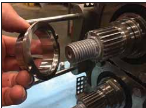
Εικόνα 101 - Τοποθετήστε τον ρυθμιστικό δακτύλιο
