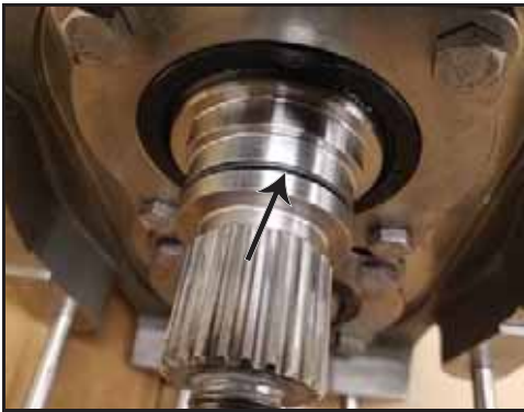
Εικόνα 161 - Τοποθετημένος στεγανοποιητικός δακτύλιος
