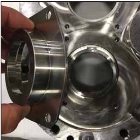
Εικόνα 57 - Τοποθετήστε το περίβλημα στεγανοποίησης
