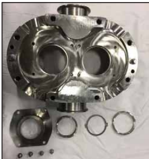
Εικόνα 50 - Μονός μηχανικός στυπιοθλίπτης (απεικονίζεται η 040-U3)
