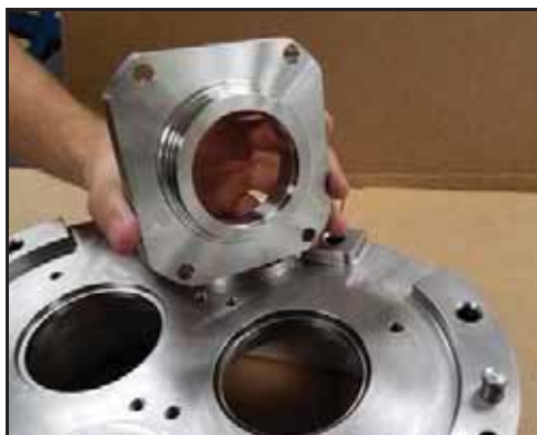
Εικόνα 156 - Ευθυγράμμιση οπών των μπουλονιών
