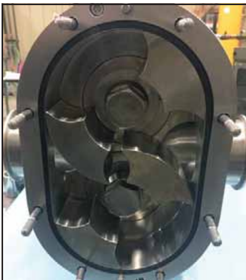
Εικόνα 185 - Τοποθετημένη φλάντζα καλύμματος
