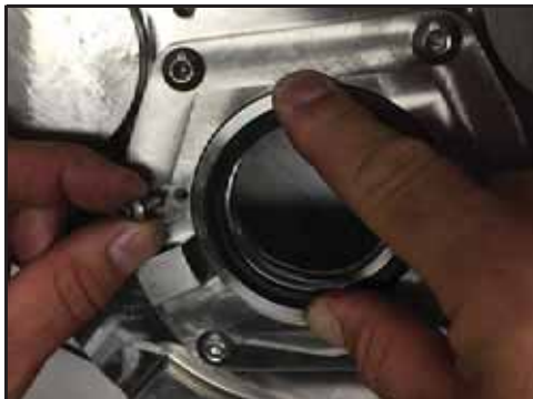
Εικόνα 96 - Τοποθετήστε τους κοχλίες συγκράτησης στεγανοποίησης
