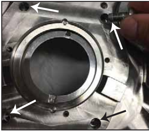
Εικόνα 74 - Μπουλόνια περιβλήματος της διάταξης στεγανοποίησης
