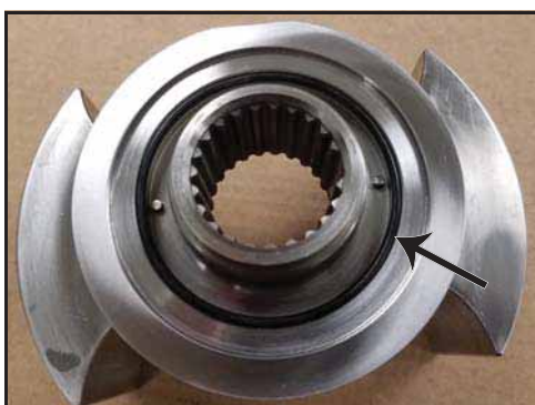
Εικόνα 170 - Τοποθετημένος εμπρόσθιος δακτύλιος στεγανοποίησης
