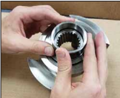
Εικόνα 172 - Πιέστε το χιτώνιο ώστε να εφαρμόσει στη θέση του
