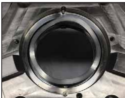
Εικόνα 93 - Τοποθετημένο ελατηριωτό παρέμβυσμα
