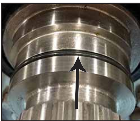
Εικόνα 100 - Τοποθετημένος στεγανοποιητικός δακτύλιος
