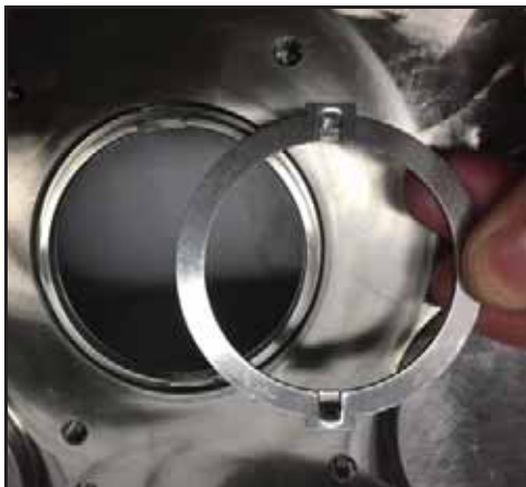
Εικόνα 48 - Αφαιρέστε τον δακτύλιο μετάδοσης κίνησης
