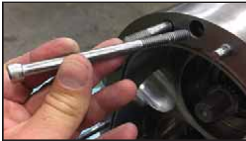
Εικόνα 42 - Αφαιρέστε τους κοχλίες συγκράτησης του σώματος
