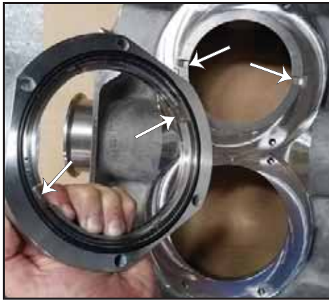
Εικόνα 110 - Τοποθετημένος δακτύλιος του περιβλήματος στεγανοποίησης
