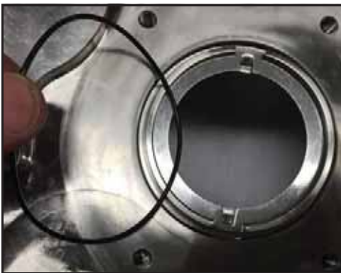
Εικόνα 85 - Τοποθέτηση δακτυλίου του περιβλήματος στεγανοποίησης
