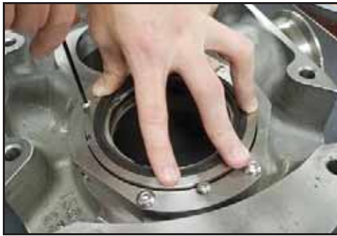
Εικόνα 117 - Τοποθετήστε τους κοχλίες συγκράτησης στεγανοποίησης
