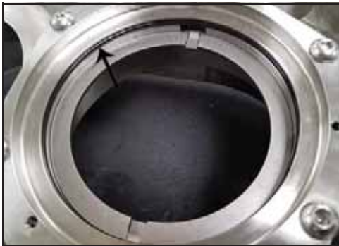
Εικόνα 114 - Θέση στεγανοποιητικών δακτυλίων
