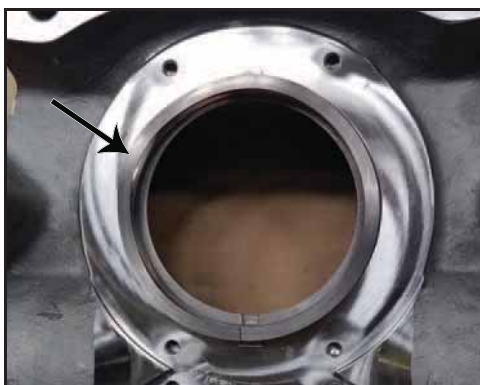
Εικόνα 62 - Τοποθετημένο ελατηριωτό παρέμβυσμα
