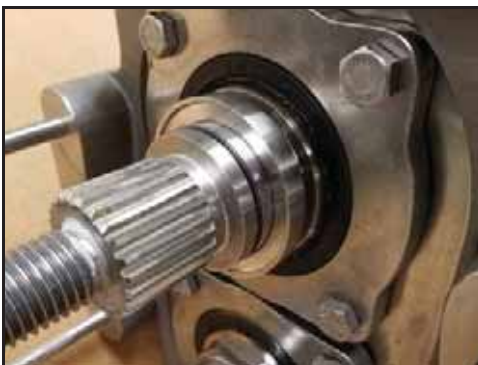
Εικόνα 163 - Τοποθετημένη έδρα παρεμβύσματος
