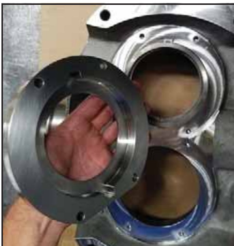
Εικόνα 46 - Αφαιρέστε το περίβλημα διάταξης στεγανοποίησης
