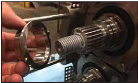
Εικόνα 121 - Τοποθετήστε τον ρυθμιστικό δακτύλιο
