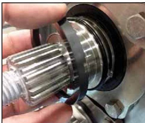
Εικόνα 66 - Αφαιρέστε το περιστρεφόμενο μέρος στεγανοποίησης από την πλευρά της έκπλυσης
