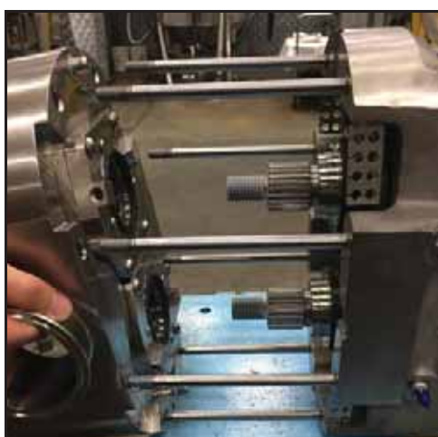
Εικόνα 148 - Αφαίρεση σώματος αντλίας
