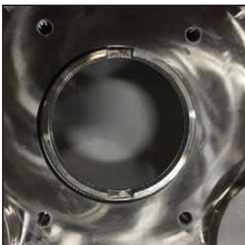
Εικόνα 82 - Τοποθετημένος δακτύλιος άξονα
