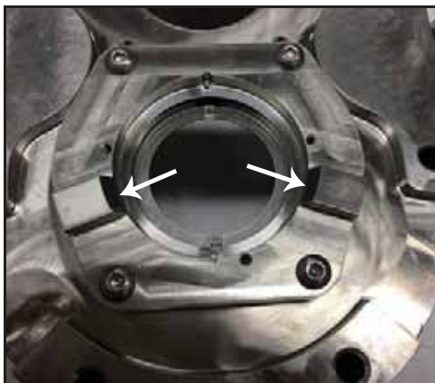
Εικόνα 89 - Τοποθετημένο περίβλημα διάταξης στεγανοποίησης
