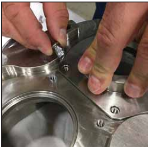
Εικόνα 44 - Αφαιρέστε τα μπουλόνια του περιβλήματος διάταξης στεγανοποίησης
