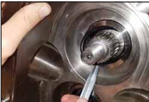
Εικόνα 143 - Αφαίρεση του δακτύλιου
