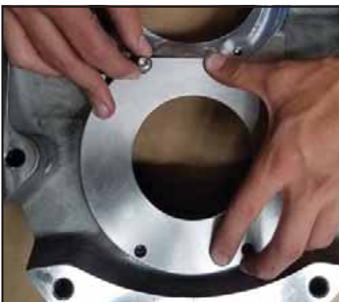
Εικόνα 64 - Τοποθετήστε τους κοχλίες περιβλήματος στεγανοποίησης
