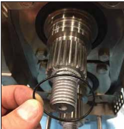
Εικόνα 99 - Τοποθετήστε τον στεγανοποιητικό δακτύλιο
