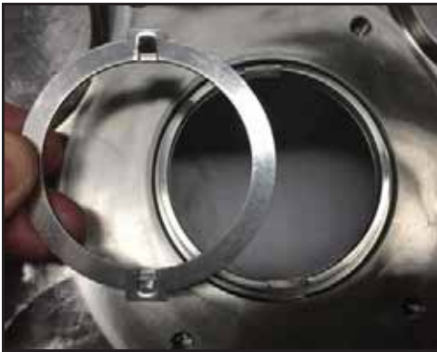
Εικόνα 83 - Τοποθετήστε τον δακτύλιο του μηχανισμού κίνησης
