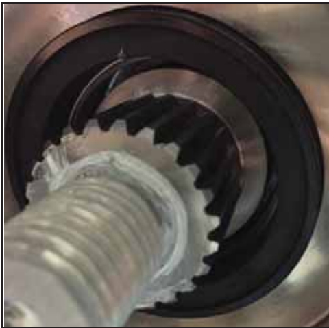
Εικόνα 134 - Τοποθετημένο στατικό παρέμβυσμα
