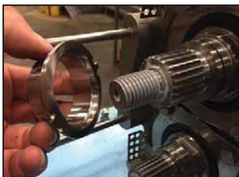
Εικόνα 68 - Αφαιρέστε τον ρυθμιστικό δακτύλιο
