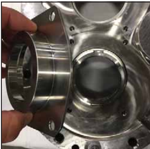
Εικόνα 45 - Αφαιρέστε το περίβλημα διάταξης στεγανοποίησης
