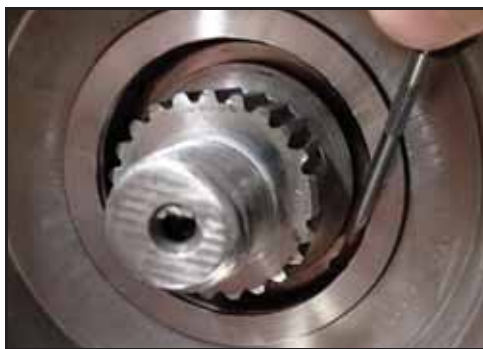
Εικόνα 145 - Αφαιρέστε τον δακτύλιο
