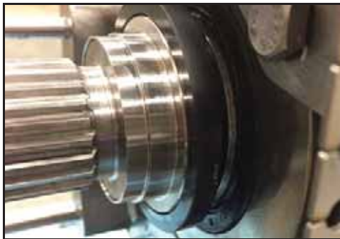
Εικόνα 126 - Τοποθετημένο περιστρεφόμενο παρεμβύσμα
