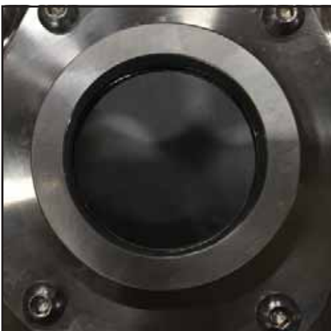
Εικόνα 59 - Τοποθετημένο περίβλημα διάταξης στεγανοποίησης
