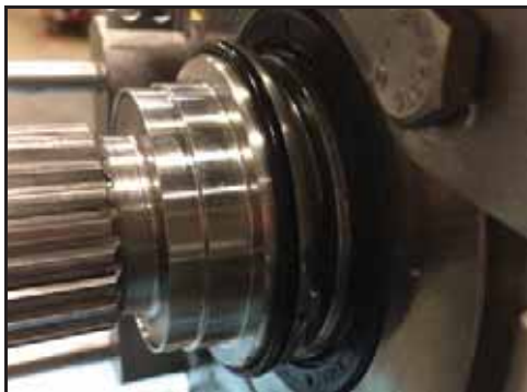
Εικόνα 104 - Τοποθετημένος στεγανοποιητικός δακτύλιος
