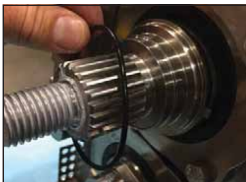
Εικόνα 67 - Αφαιρέστε τον δακτύλιο
