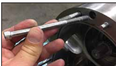
Εικόνα 147 - Αφαιρέστε τους κοχλίες συγκράτησης του σώματος
