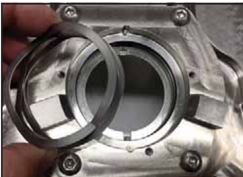
Εικόνα 72 - Αφαιρέστε το ελατηριωτό παρέμβυσμα
