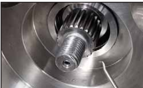
Εικόνα 144 - Αφαίρεση του δακτύλιου στεγανοποίησης
