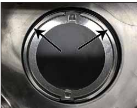
Εικόνα 86 - Τοποθετημένος δακτύλιος του περιβλήματος στεγανοποίησης
