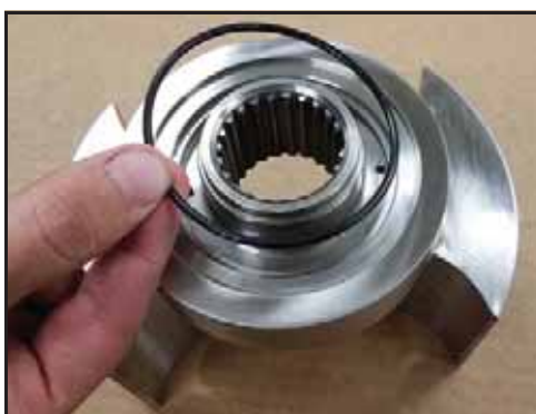
Εικόνα 169 - Τοποθετήστε τον εμπρόσθιο δακτύλιο του χιτωνίου
