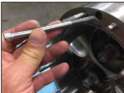
Εικόνα 167 - Τοποθετήστε τους κοχλίες συγκράτησης του σώματος
