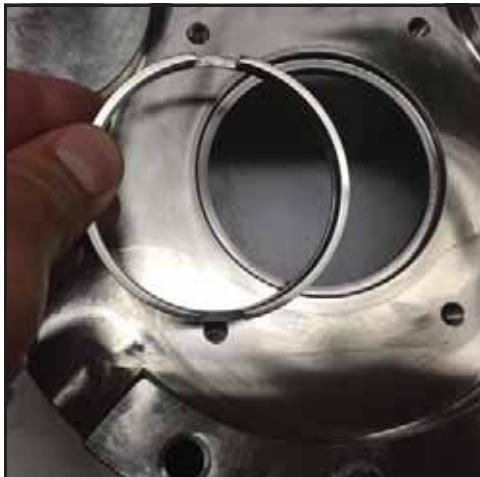
Εικόνα 81 - Τοποθετήστε τον δακτύλιο του άξονα
