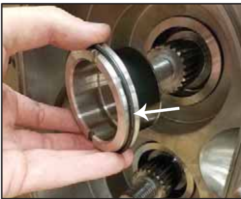
Εικόνα 142 - Αφαίρεση χιτωνίου, δακτύλιος
