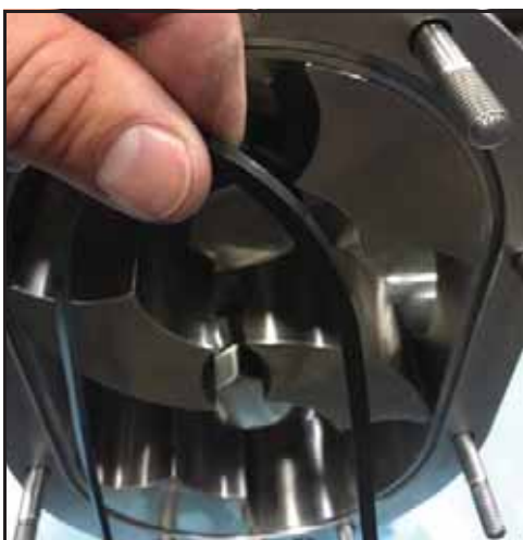
Εικόνα 34 - Αφαιρέστε τη φλάντζα
