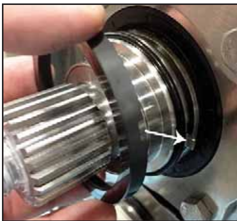
Εικόνα 105 - Τοποθέτηση περιστρεφόμενου παρεμβύσματος της πλευράς έκπλυσης
