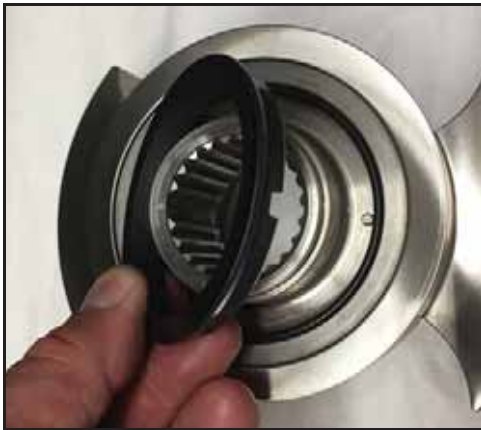
Εικόνα 38 - Αφαιρέστε το περιστρεφόμενο παρέμβυσμα
