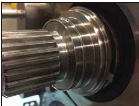
Εικόνα 122 - Τοποθετημένος ρυθμιστικός δακτύλιος
