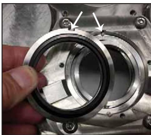
Εικόνα 94 - Τοποθέτηση στατικού παρεμβύσματος της πλευράς έκπλυσης
