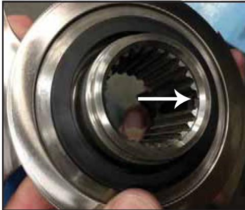
Εικόνα 175 - Οδοντώσεις χρονισμού ρότορα
