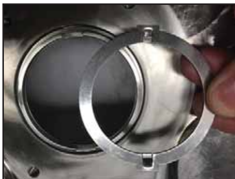
Εικόνα 78 - Αφαιρέστε τον δακτύλιο μετάδοσης κίνησης
