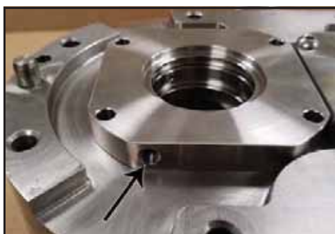
Εικόνα 157 - Θέση οπής έκπλυσης
