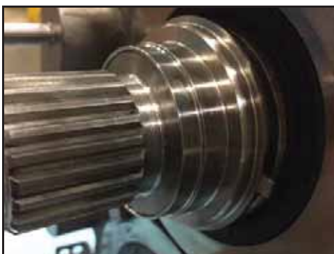
Εικόνα 102 - Τοποθετημένος ρυθμιστικός δακτύλιος
