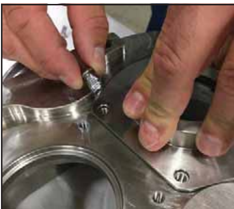
Εικόνα 58 - Τοποθετήστε τους κοχλίες περιβλήματος στεγανοποίησης
