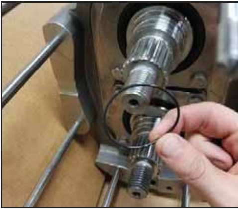
Εικόνα 160 - Λίπανση και τοποθέτηση δακτυλίου στεγανοποίησης
