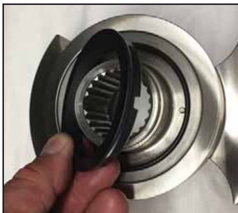
Εικόνα 137 - Τοποθετήστε το περιστρεφόμενο παρέμβυσμα
