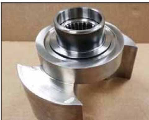
Εικόνα 173 - Τοποθετημένο στεγανοποιητικό χιτώνιο
