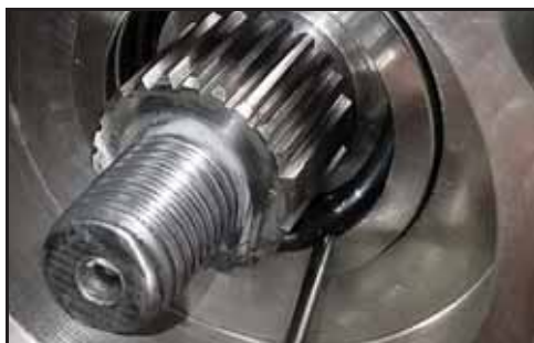
Εικόνα 146 - Αφαιρέστε τον δακτύλιο
