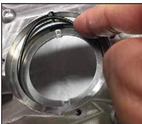
Εικόνα 90 - Τοποθετήστε τον στατικό στεγανοποιητικό δακτύλιο
