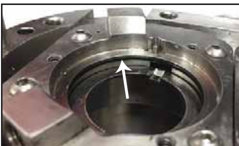
Εικόνα 73 - Θέση στεγανοποιητικών δακτυλίων
