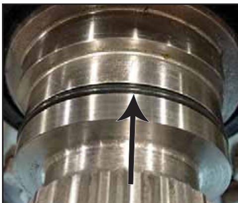
Εικόνα 120 - Τοποθετημένος στεγανοποιητικός δακτύλιος
