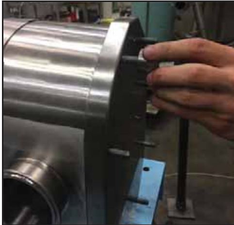
Εικόνα 187 - Τοποθετήστε τα περικόχλια του καλύμματος
