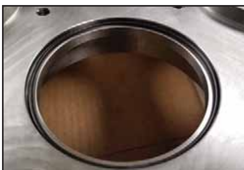
Εικόνα 155 - Τοποθετημένος δακτύλιος του περιβλήματος στεγανοποίησης
