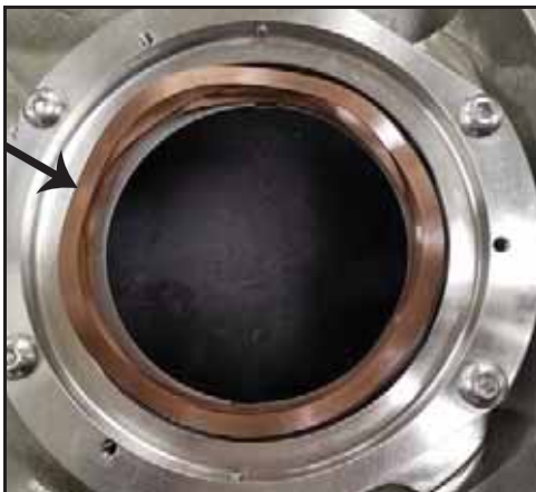
Εικόνα 115 - Τοποθετημένο ελατηριωτό παρέμβυσμα
