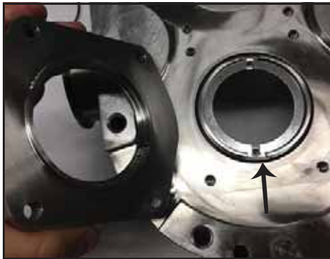
Εικόνα 75 - Αφαιρέστε το περίβλημα διάταξης στεγανοποίησης
