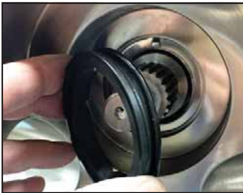
Εικόνα 40 - Αφαιρέστε το στατικό παρέμβυσμα
