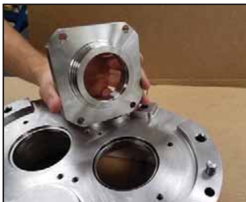
Εικόνα 150 - Αφαίρεση περιβλήματος διάταξης στεγανοποίησης
