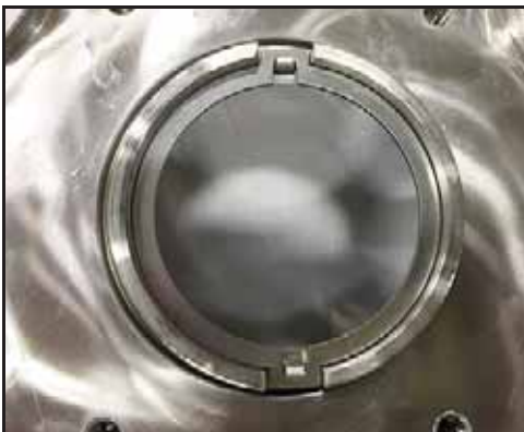
Εικόνα 84 - Τοποθετημένος δακτύλιος μηχανισμού κίνησης
