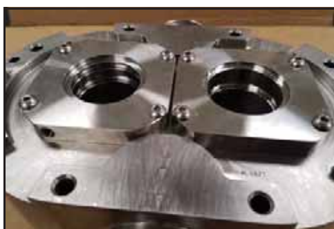
Εικόνα 159 - Τοποθετημένα περιβλήματα παρεμβυσμάτων
