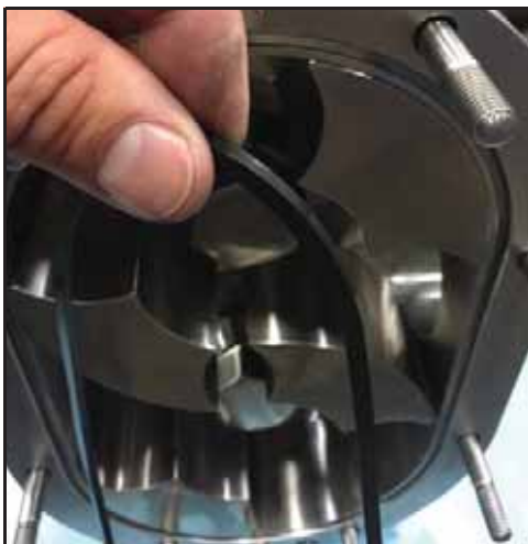
Εικόνα 184 - Τοποθετήστε τη φλάντζα του καλύμματος
