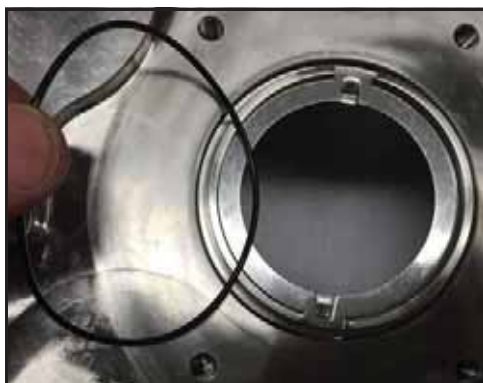
Figur 85 - Installere O-ring i tetningshuset
