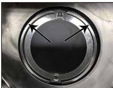
Figur 86 - O-ring installert i tetningshus
