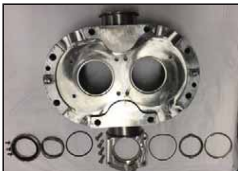
Figur 80 - Dobbelt mekanisk tetning (040-U3 avbildet)
