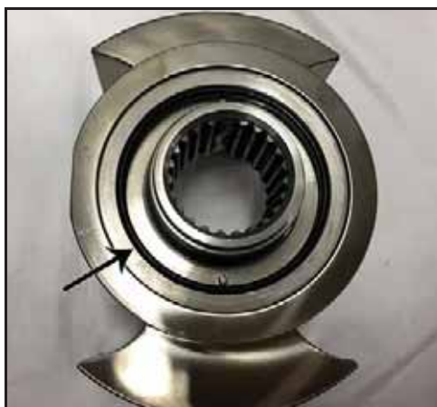
Figur 136 - O-ring installert på tetning
