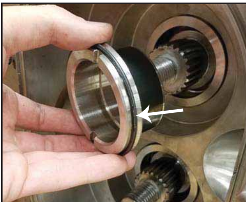
Figur 142 - Fjerne foring, O-ring
