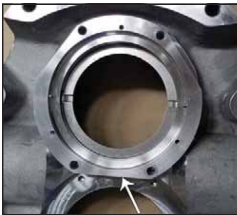
Figur 111 - Tetningshuset på plass
