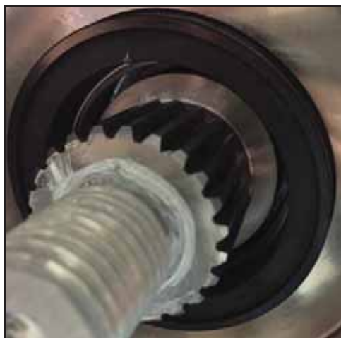
Figur 134 - Stasjonær tetning installert
