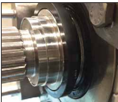
Figur 106 - Roterende tetning installert
