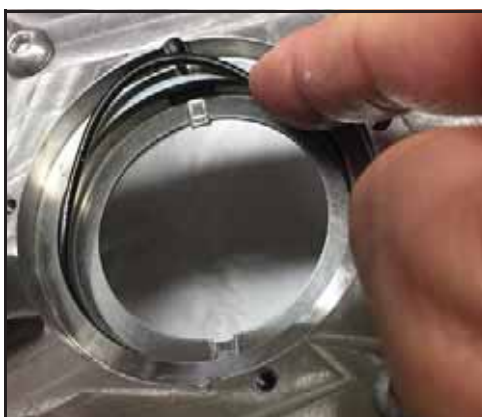
Figur 90 - Installere O-ringen i tetningen
