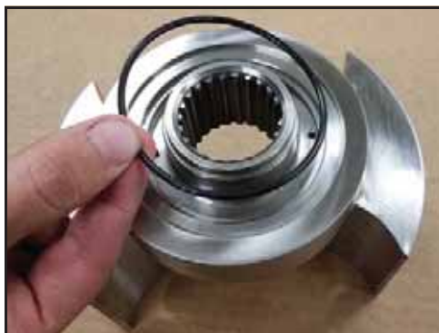
Figur 169 - Installere den fremre O-ringen i foringen
