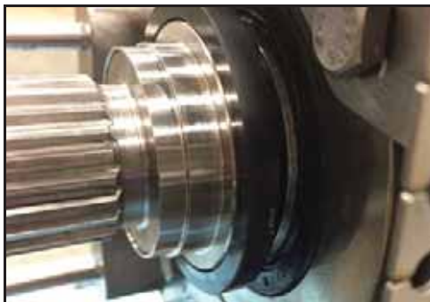
Figur 126 - Roterende tetning installert
