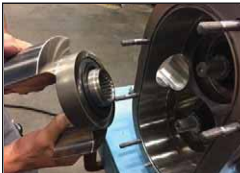
Figur 177 - Skyve rotoren inn på akselen
