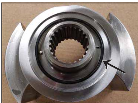
Figur 170 - Fremre O-ring til foring installert
