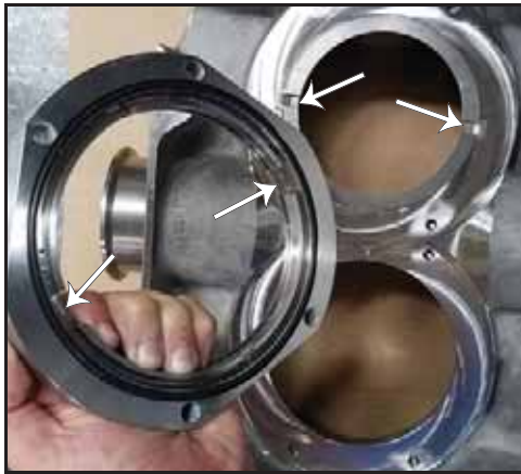
Figur 110 - O-ring installert i tetningshuset
