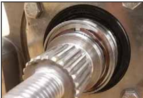
Figura 164 - Instalar a mola ondulada
