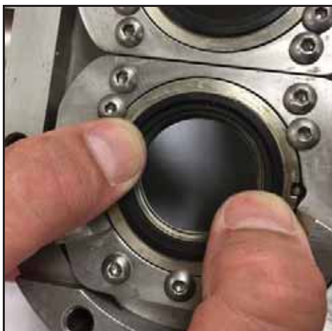
Figura 98 - Aplicar uma pressão com um dedo
