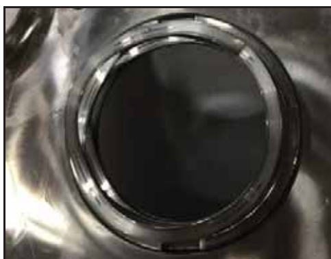
Figura 56 - Mola ondulada instalada
