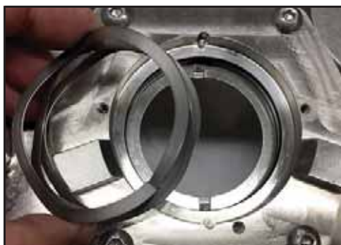
Figura 92 - Instalar a mola ondulada
