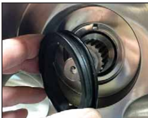
Figura 40 - Remover a vedação estacionária
