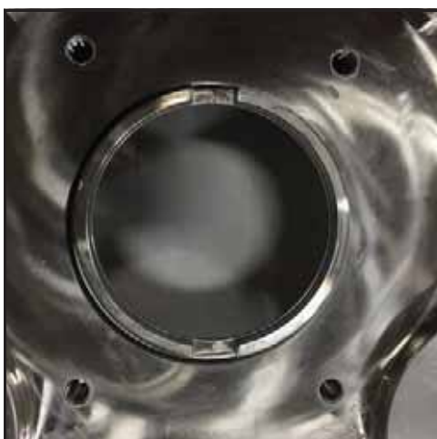
Figura 82 - Anel do eixo instalado
