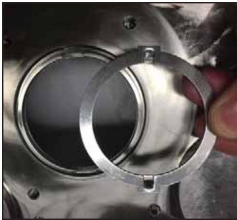
Figura 48 - Remover o anel de acionamento
