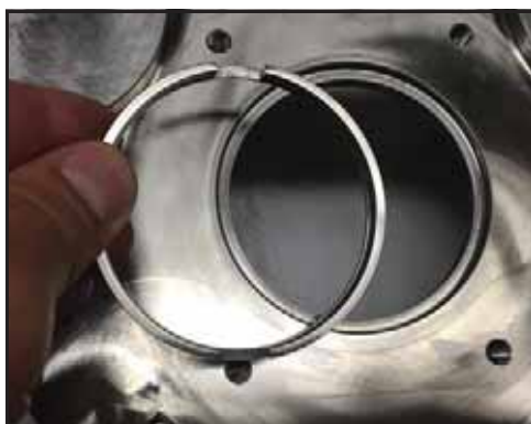
Figura 51 - Instalar o anel do eixo
