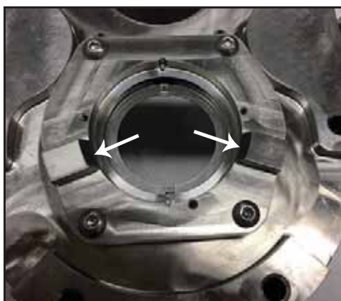
Figura 89 - Alojamento da vedação instalado
