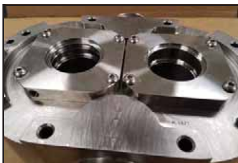
Figura 159 - Alojamentos das vedações instalados
