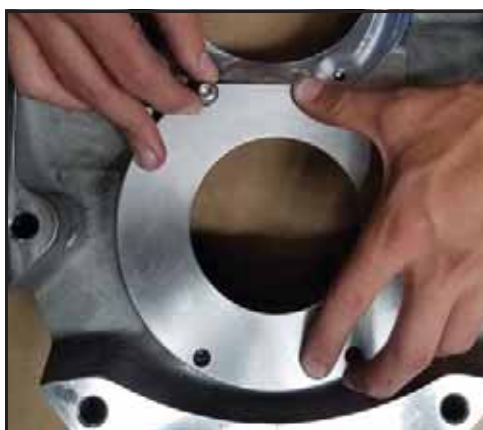
Figura 64 - Instalar os parafusos do alojamento da vedação
