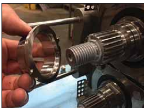
Figura 68 - Remover o anel de ajuste
