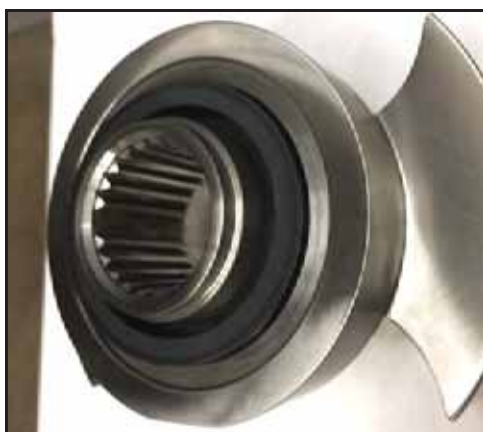
Figura 138 - Vedação giratória instalada
