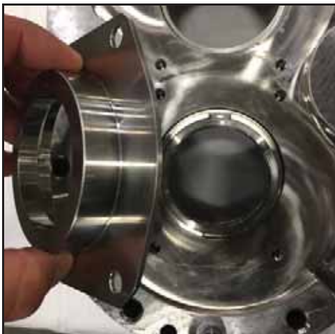
Figura 57 - Instalar o alojamento da vedação
