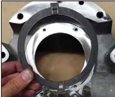
Figura 60 - Instalar o anel de acionamento
