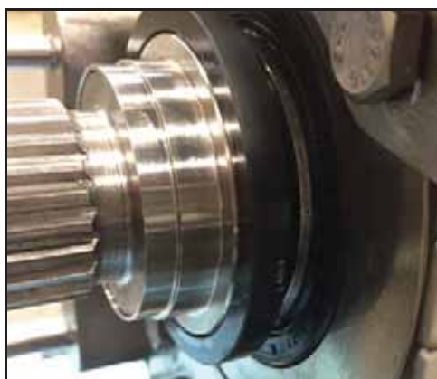
Figura 106 - Vedação giratória instalada
