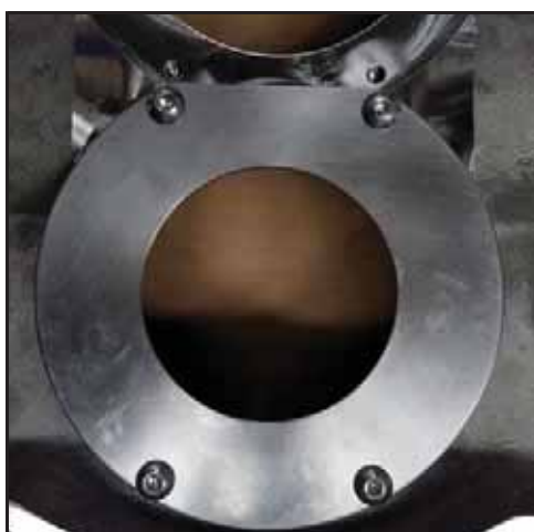
Figura 65 - Alojamento da vedação instalado
