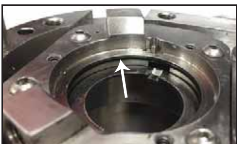
Figura 73 - Localização do anel O-ring da vedação
