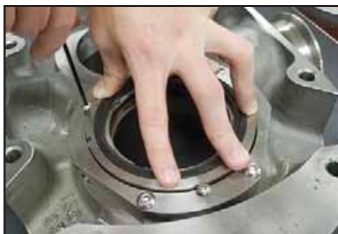
Figura 117 - Instalar os parafusos de retenção da vedação
