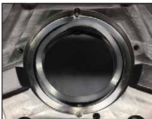
Figura 93 - Mola ondulada instalada
