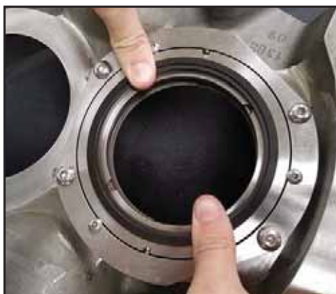
Figura 118 - Aplicar uma pressão com um dedo
