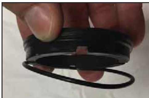
Figura 41 - Anel O-ring da vedação estacionária
