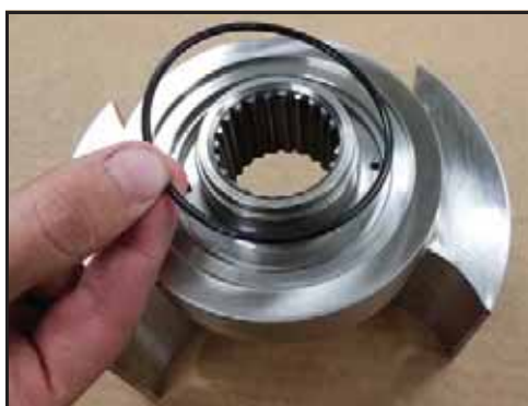
Figura 169 - Instalar o anel O-ring dianteiro da luva
