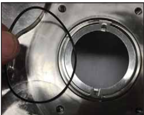
Figura 85 - Instalar o anel O-ring do alojamento da vedação
