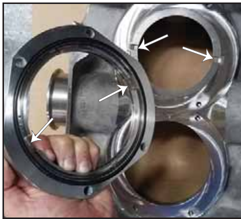
Figura 110 - Anel O-ring do alojamento da vedação instalado
