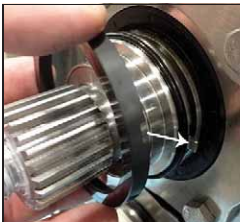
Figura 105 - Instalar a vedação giratória do lado de descarga
