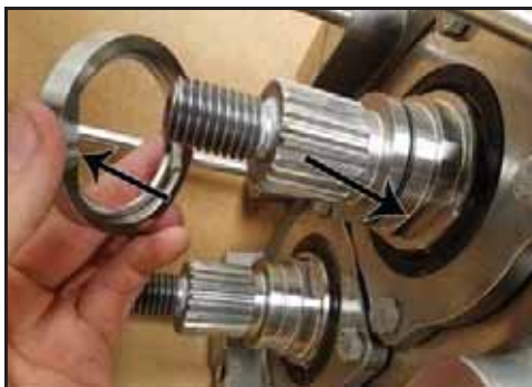
Figura 162 - Instalar o assento da vedação
