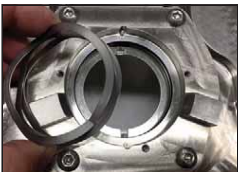
Figura 72 - Remover a mola ondulada
