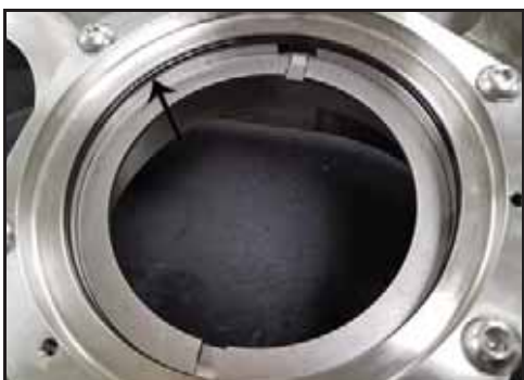
Figura 114 - Localização do anel O-ring da vedação
