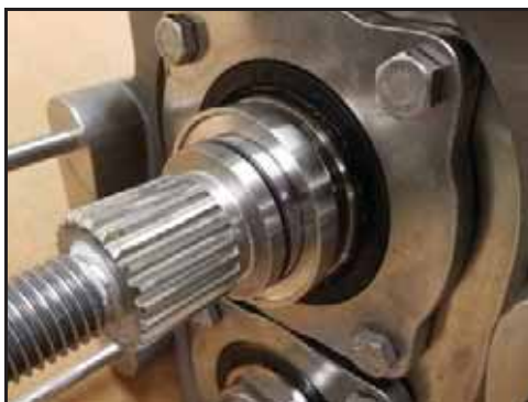
Figura 163 - Assento da vedação instalado
