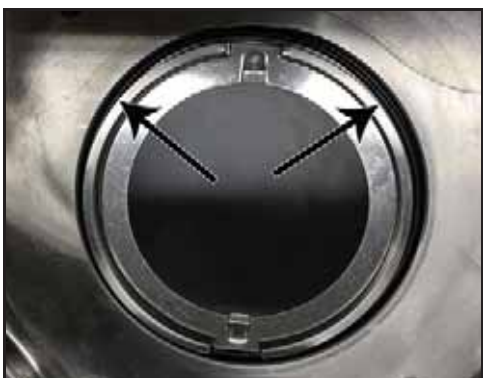
Figura 86 - Anel O-ring do alojamento da vedação instalado
