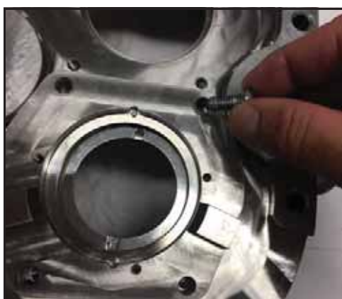
Figura 88 - Parafusos do alojamento da vedação
