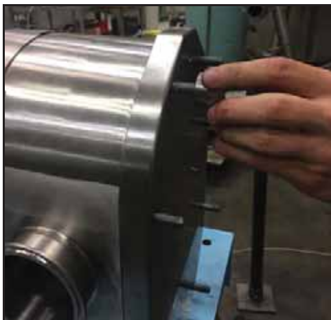
Figura 187 - Instalar as porcas da tampa da tampa
