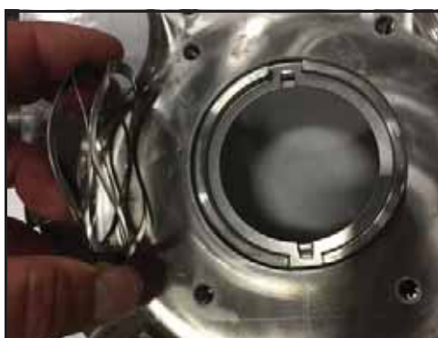
Figura 55 - Instalar a mola ondulada
