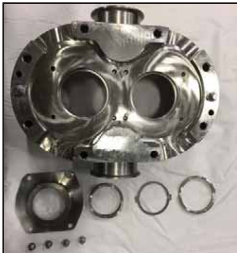
Figura 50 - Vedação mecânica única (040-U3 mostrada)
