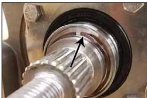
Figura 152 - Remover a mola ondulada
