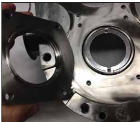
Figura 87 - Instalar o alojamento da vedação
