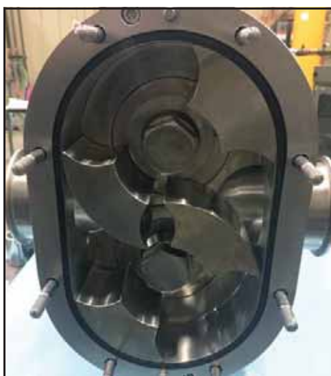
Figura 185 - Junta da tampa instalada
