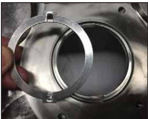
Figura 83 - Instalar o anel de acionamento
