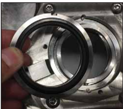
Figura 71 - Remover a vedação estacionária
