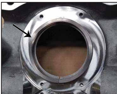
Figura 62 - Mola ondulada instalada
