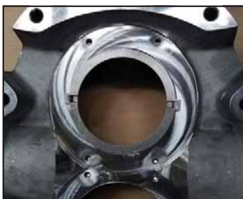
Figura 108 - Anel de acionamento instalado
