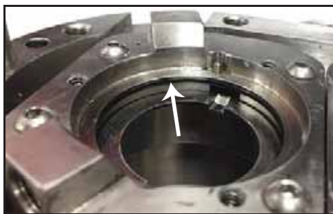
Figura 91 - Localização do anel O-ring da vedação
