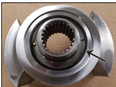
Figura 170 - Anel O-ring dianteiro da luva instalado
