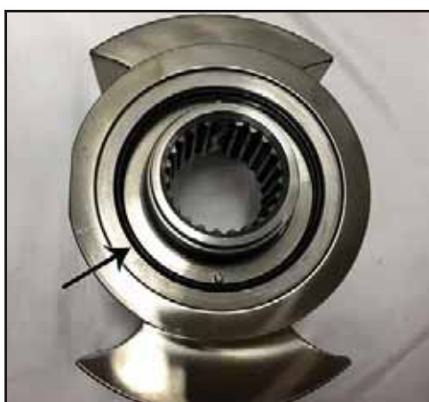
Figura 136 - Anel O-ring da vedação instalado
