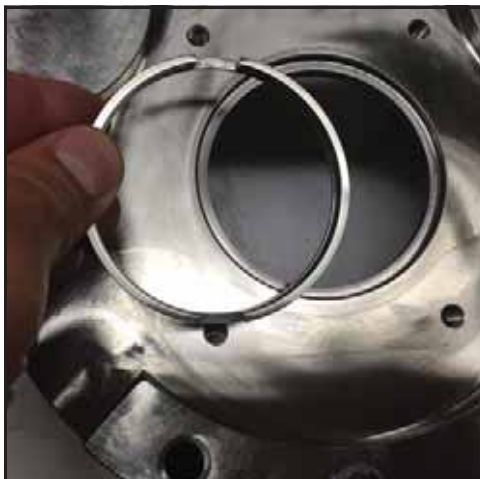
Figura 81 - Instalar o anel do eixo
