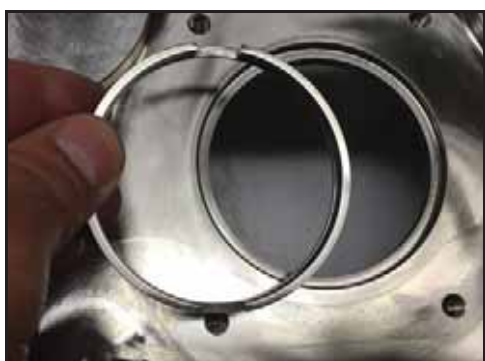
Figura 79 - Remover o anel do eixo
