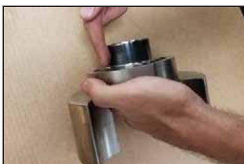
Figura 174 - Lubrificar a luva da vedação
