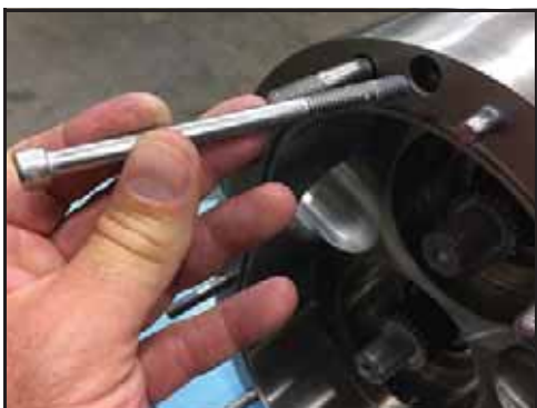
Figura 129 - Instalar os parafusos de retenção da carcaça
