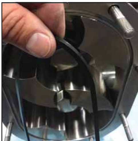
Figura 34 - Remover a junta da tampa
