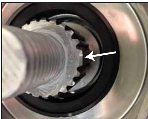
Figura 176 - Estria de sincronismo do eixo
