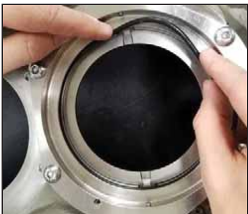
Figura 113 - Instalar o anel O-ring da vedação
