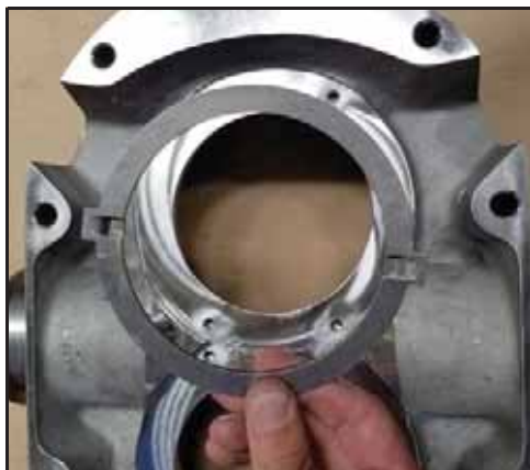
Figura 107 - Instalar o anel de acionamento
