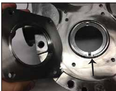
Figura 75 - Remover o alojamento da vedação
