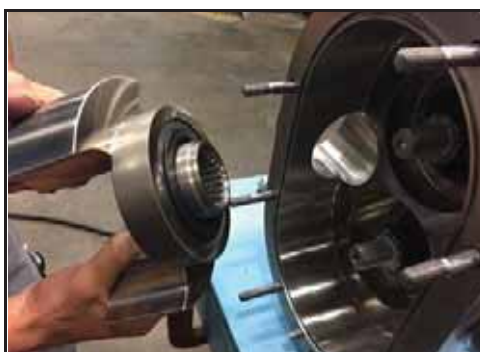
Figura 177 - Empurrar o rotor no eixo
