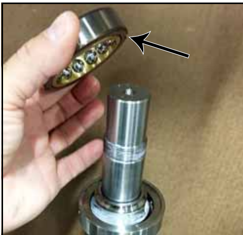
Figur 165 - Plassere lager på løp
