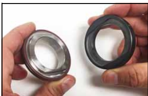
Figur 44 - Demontere tetningssete fra tetningshette
