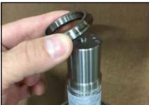
Figur 162 - Plassere løp på aksel
