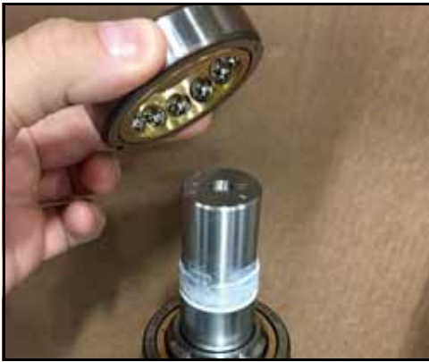
Figur 170 - Plassere lager på løp
