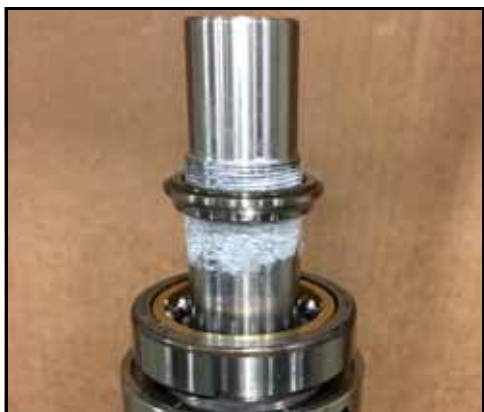
Figur 166 - Plassere løp på aksel
