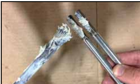
Figur 89 - Påføre gjengepasta på gjengene
