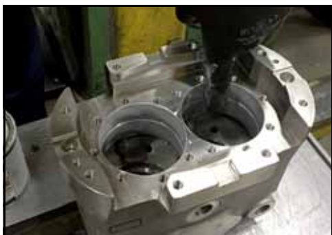
Figur 185 - Spre på jevnt lag
