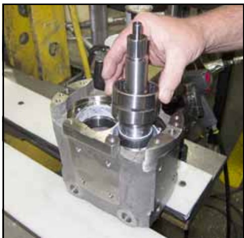
Figur 188 - Plassere ytre løp på aksel
