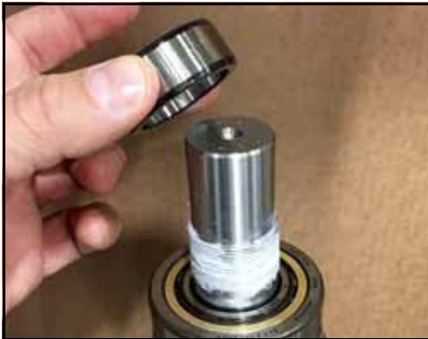
Figur 175 - Plassere løp på aksel
