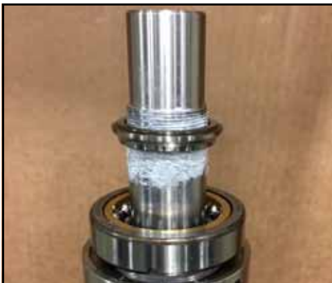
Figur 171 - Plassere løp på aksel
