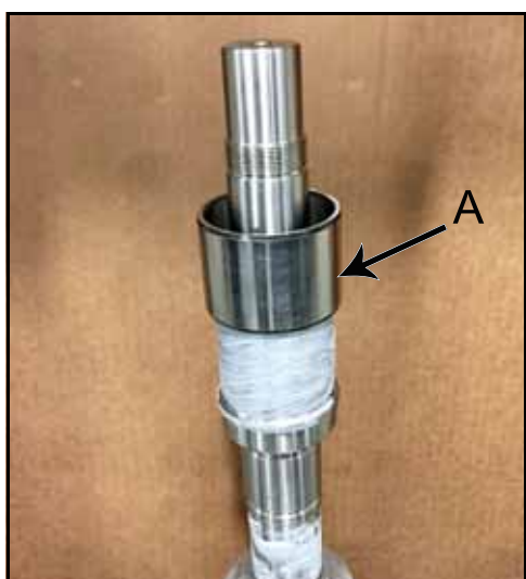
Figur 154 - Plassere indre løp på aksel
