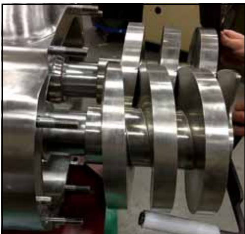
Figur 110 - Skyve skruer på aksler
