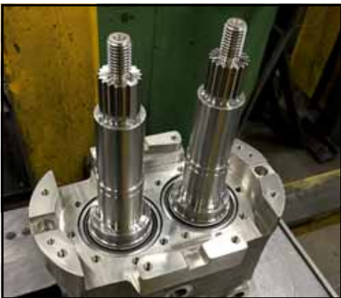
Figur 192 - Aksler montert i girkasse
