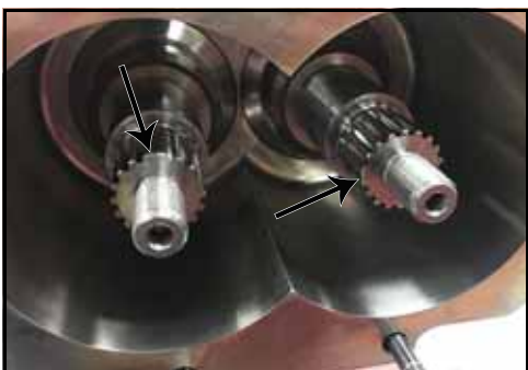
Figur 108 - Innrette skruer og akselrille
