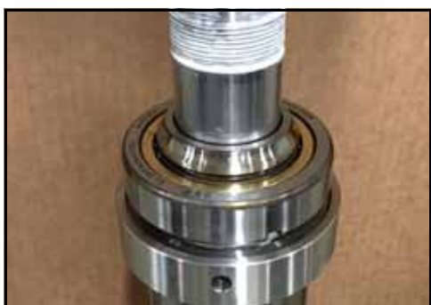
Figur 169 - Presse løp inn i lager
