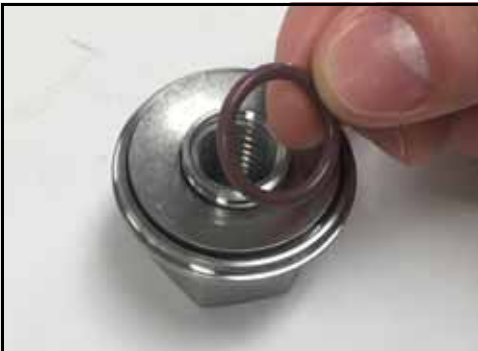
Figur 39 - Fjerne skiveholderens O-ring
