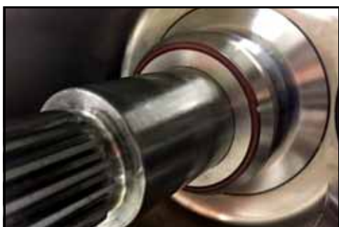
Figur 104 - Tetningshette montert på aksel
