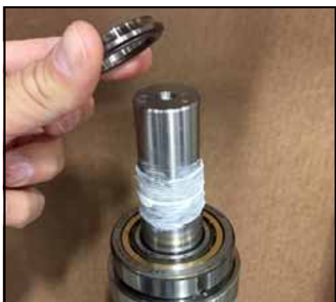
Figur 168 - Plassere løp på aksel
