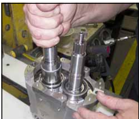
Figur 189 - Plassere drivaksel i boring
