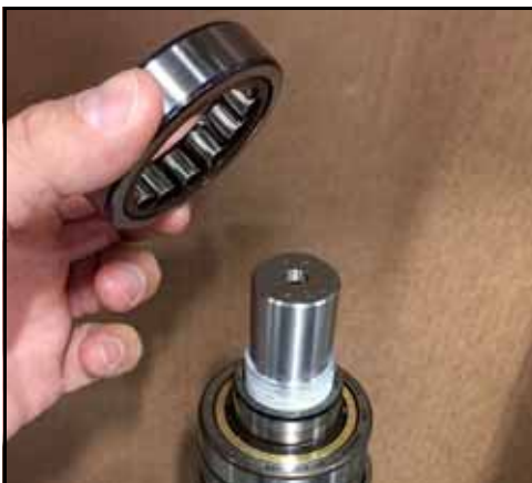
Figur 177 - Plassere lager på løp
