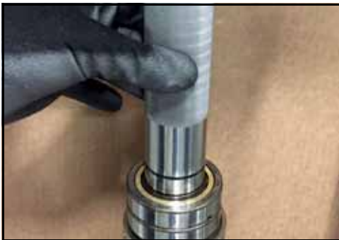
Figur 176 - Presse løp på aksel
