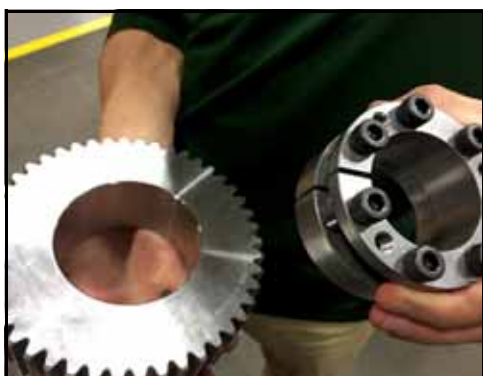
Figur 211 - Montere låseenheten i giret
