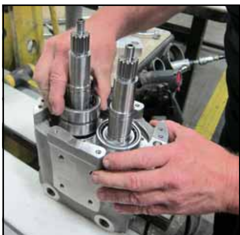
Figur 190 - Plassere ytre løp på aksel
