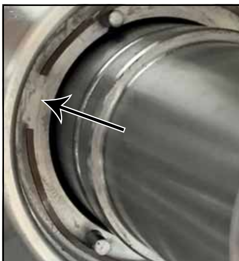
Figura 68 - Posição da mola ondulada da vedação
