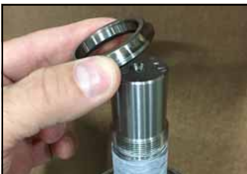
Figura 162 - Colocar a pista sobre o eixo
