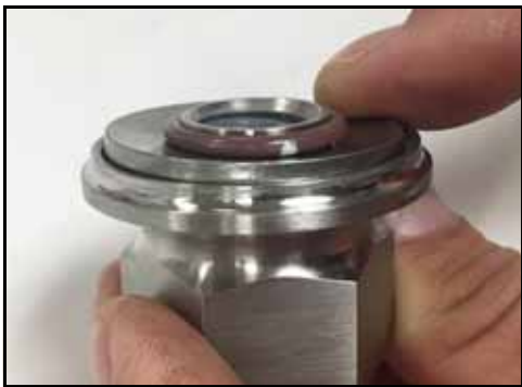
Figura 115 - Arruela Belleville instalada
