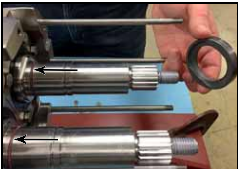
Figura 54 - Remover os anéis O-ring dos eixos
