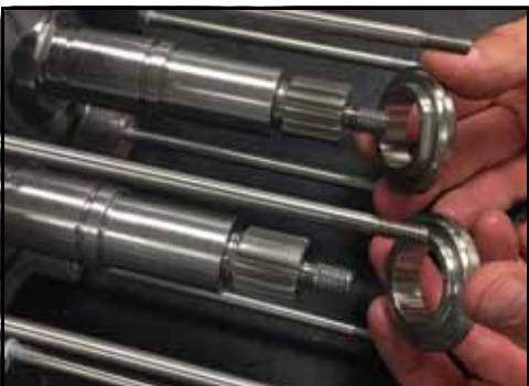
Figura 215 - Instalar as tampas de vedação
