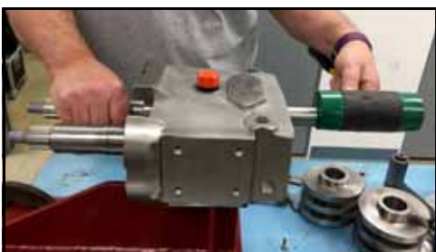
Figura 145 - Soltar o eixo de acionamento da caixa de engrenagem
