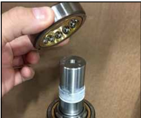
Figura 170 - Colocar o rolamento na pista
