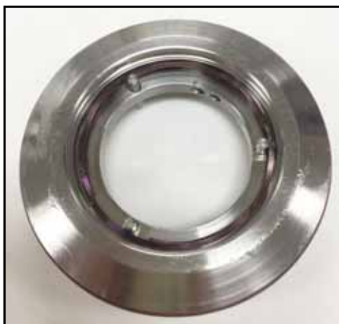
Figura 67 - Mola ondulada da vedação instalada
