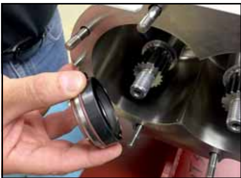
Figura 43 - Remover o conjunto da tampa de vedação
