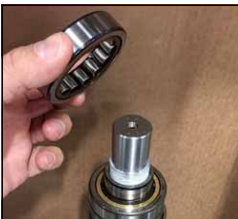
Figura 177 - Colocar o rolamento na pista
