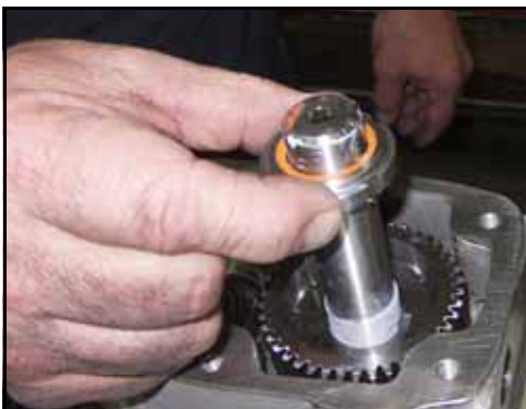
Figura 204 - Instalar a contraporca
