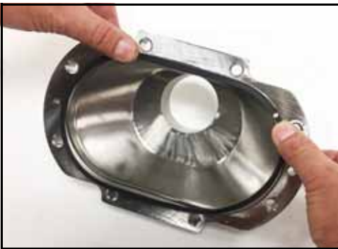
Figura 127 - Instalar a junta da tampa
