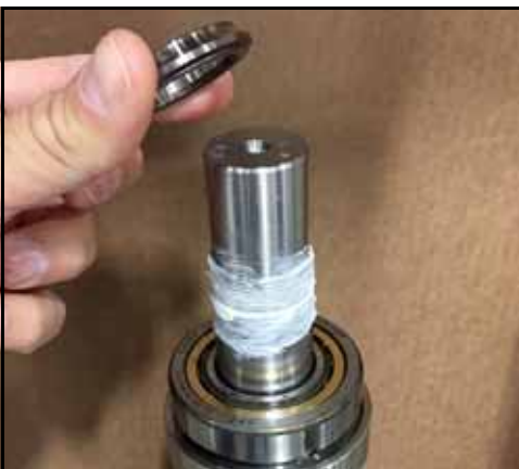
Figura 168 - Colocar a pista no eixo
