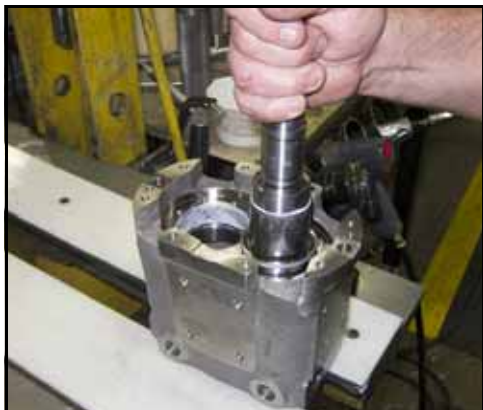
Figura 186 - Colocar o eixo curto no orifício
