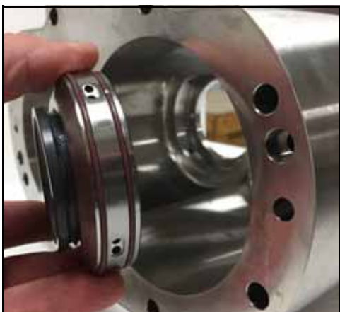
Figura 57 - Remover o suporte de vedação da carcaça
