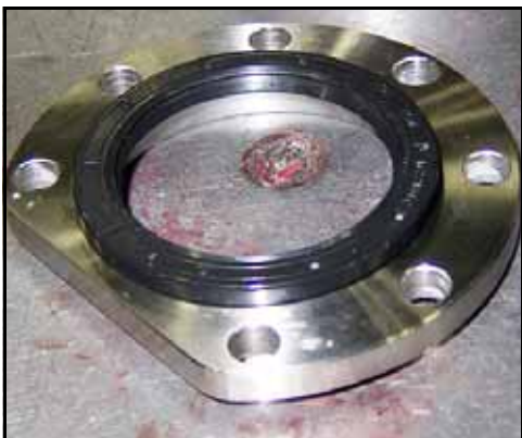
Figura 193 - Centralizar a vedação do retentor de rolamento
