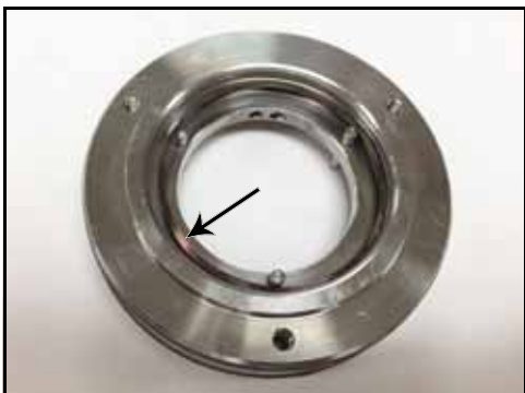
Figura 71 - Mola ondulada da vedação instalada
