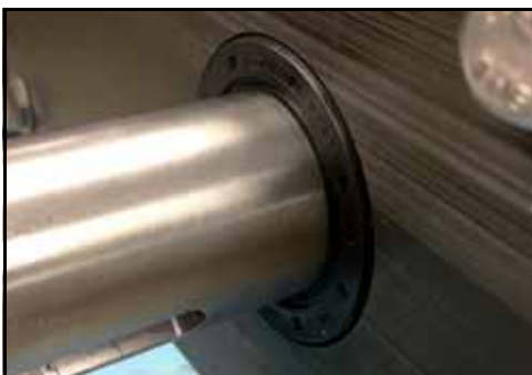
Figura 239 - Vedação de óleo instalada
