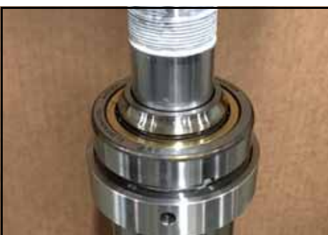
Figura 169 - Pressionar a pista no rolamento
