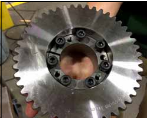
Figura 212 - Colocar o conjunto de travamento na engrenagem
