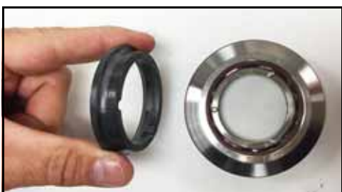
Figura 73 - Lubrificar e instalar a vedação
