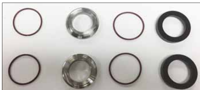
Figura 96 - Componentes do conjunto da tampa de vedação
