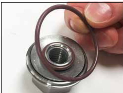
Figura 116 - Instalar o anel O-ring da porca do fuso
