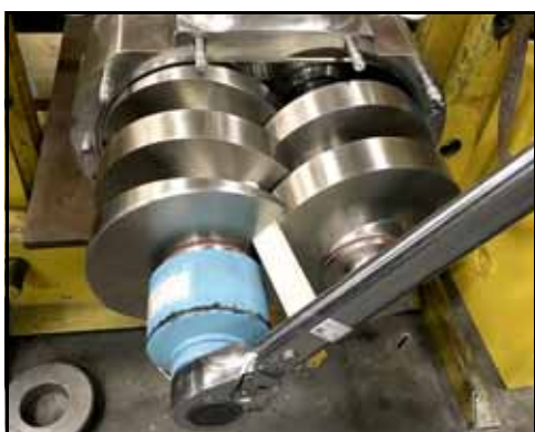
Figura 125 - Apertar a porca do fuso esquerdo
