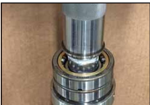
Figura 172 - Pressionar a pista no rolamento
