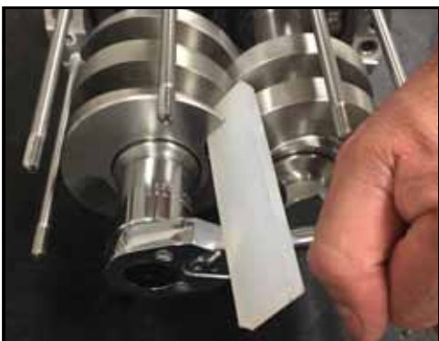
Figura 219 - Instalar as porcas dos fusos
