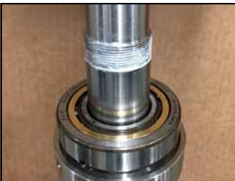
Figura 167 - Pista instalada no eixo
