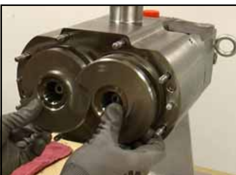
Figura 41 - Remover os fusos
