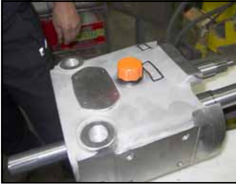
Figura 208 - Instalar o bujão de ventilação de óleo
