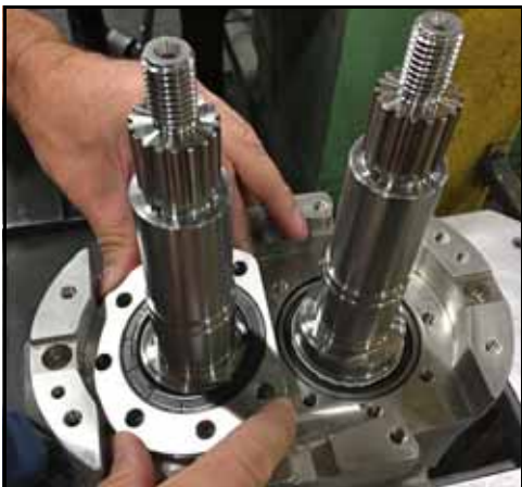
Figura 144 - Remover o retentor de rolamento
