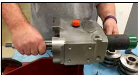
Figura 147 - Soltar o eixo curto da caixa de engrenagem
