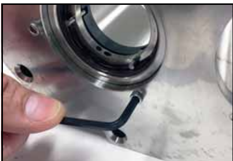
Figura 56 - Remover os parafusos de cabeça cilíndrica
