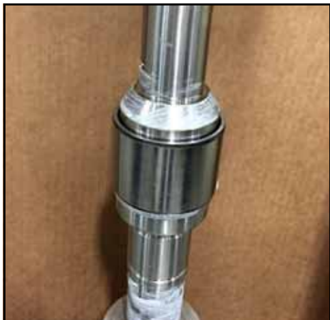
Figura 156 - Pista interna instalada no eixo
