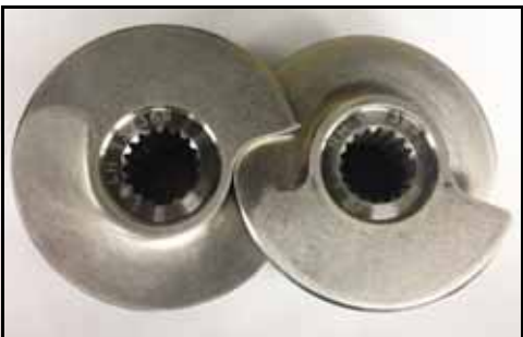
Figura 107 - Disposição dos fusos: LH-RH
