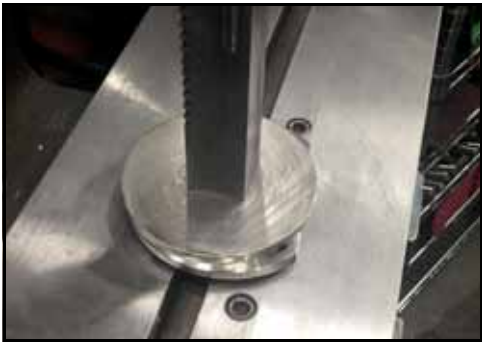
Figura 194 - Instalar a vedação do retentor de rolamento
