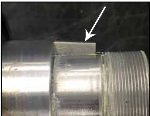
Figura 183 - Posicionar a chaveta
