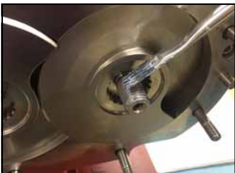
Figura 118 - Aplicar composto antigripante
