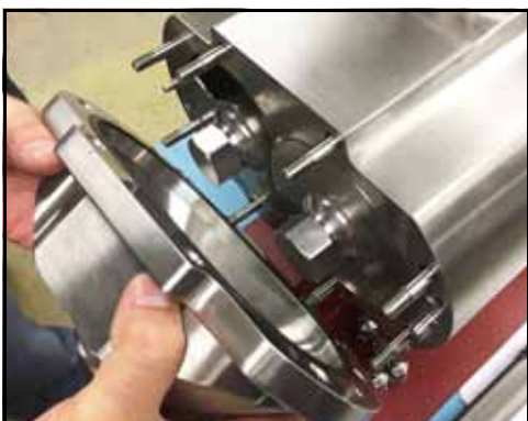
Figura 28 - Remover a tampa da bomba
