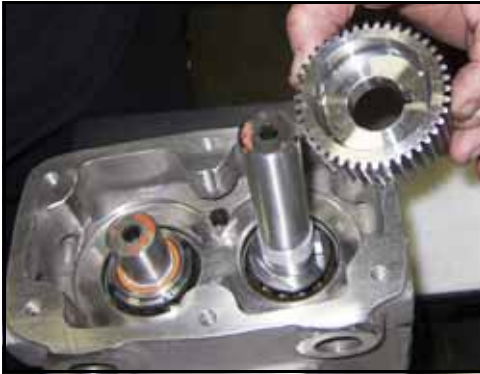
Figura 202 - Instalar a engrenagem de acionamento
