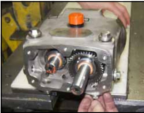
Figura 209 - Instalar os bujões
