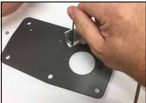
Figura 232 - Apertar os parafusos das coberturas de proteção
