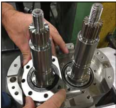
Figura 199 - Instalar o retentor de rolamento
