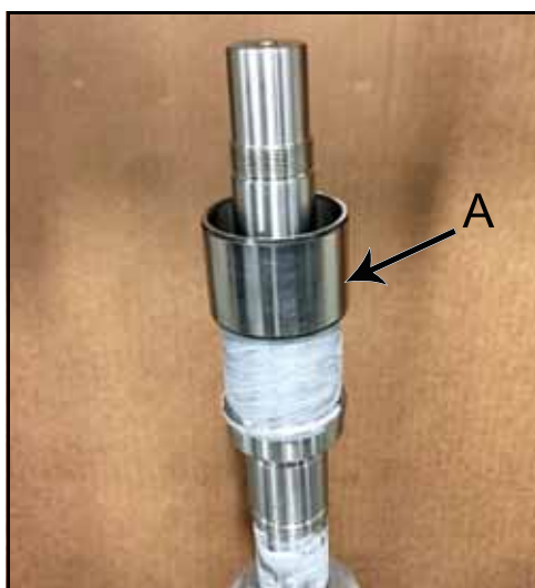
Figura 154 - Colocar a pista interna no eixo
