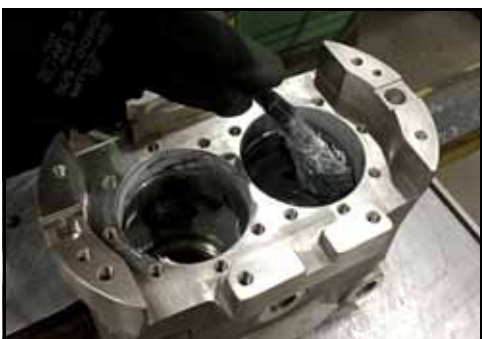
Figura 184 - Aplicar composto antigripante
