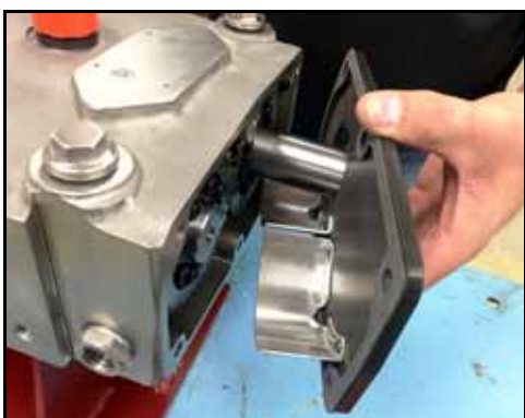
Figura 235 - Instalar a tampa da caixa de engrenagem
