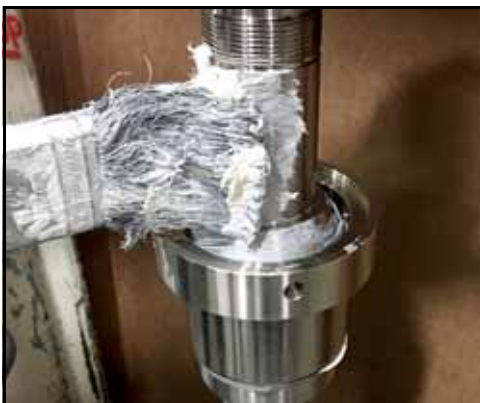
Figura 161 - Aplicar composto antigripante no eixo
