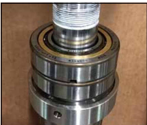
Figura 173 - Segundo rolamento instalado
