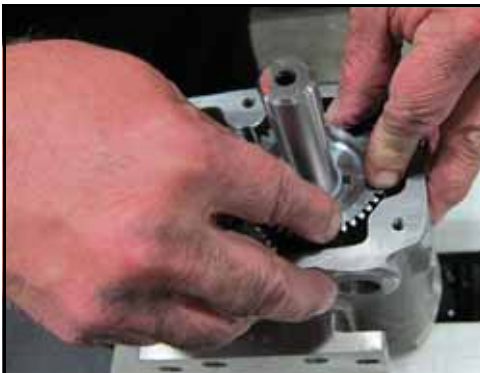
Figura 203 - Instalar a engrenagem de acionamento
