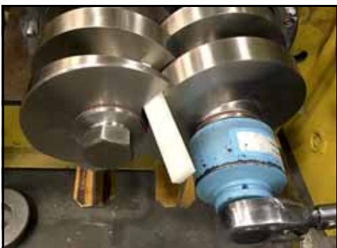
Figura 36 - Inserir o bloqueio
