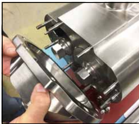
Figura 128 - Instalar a tampa da bomba
