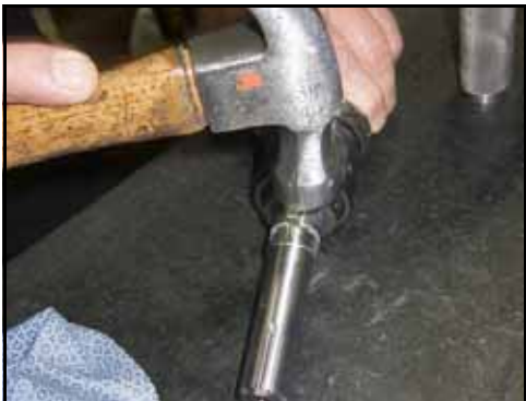
Figura 182 - Fixar a chaveta no rasgo do eixo
