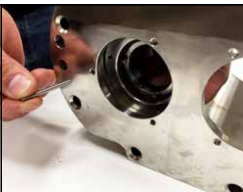
Figura 77 - Usar o pino de desvio para alinhar os orifícios
