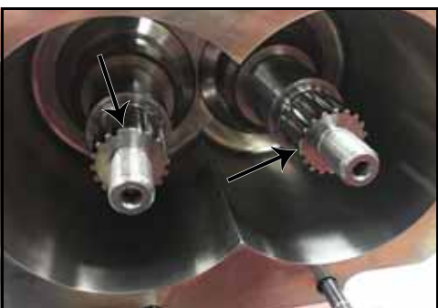
Figura 108 - Alinhar o fuso e a estria do eixo
