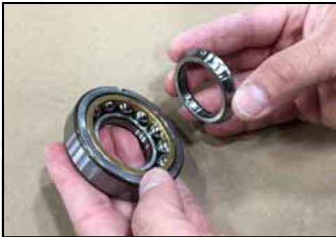
Figura 160 - Remover a pista inferior
