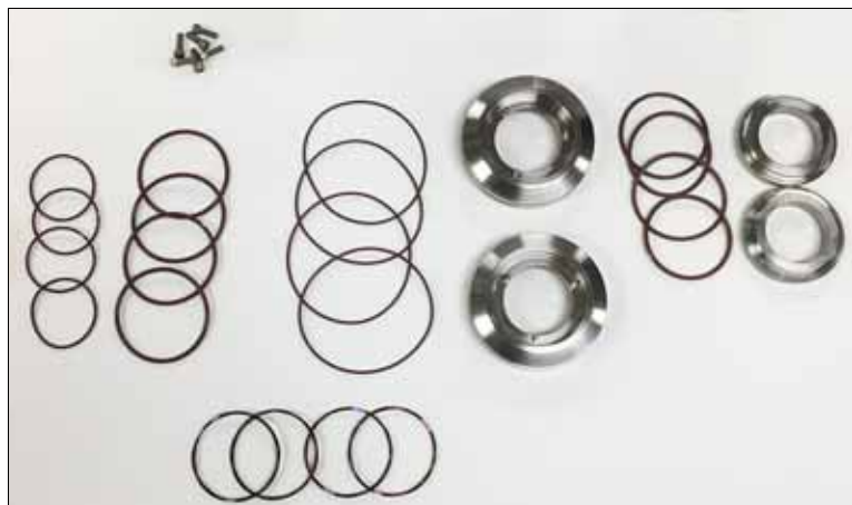
Figura 63 - Componentes de montagem da vedação
