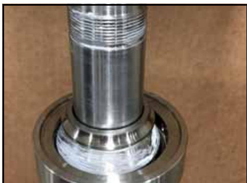
Figura 164 - Pista pressionada no eixo
