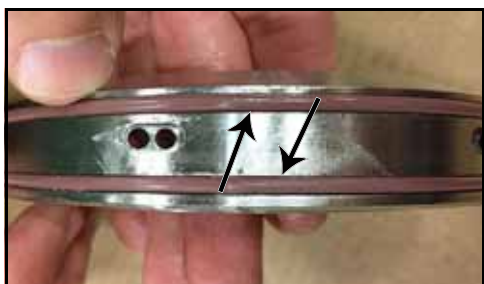
Figura 62 - Anéis O-ring entre o suporte e a carcaça
