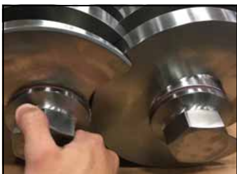
Figura 124 - Instalar as porcas dos fusos
