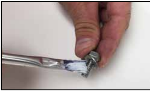
Figura 236 - Aplicar composto antigripante
