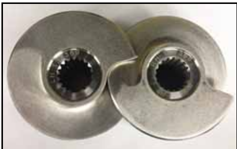
Figura 42 - Fusos dispostos LH - RH
