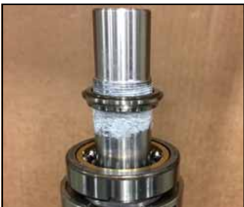
Figura 171 - Colocar a pista no eixo
