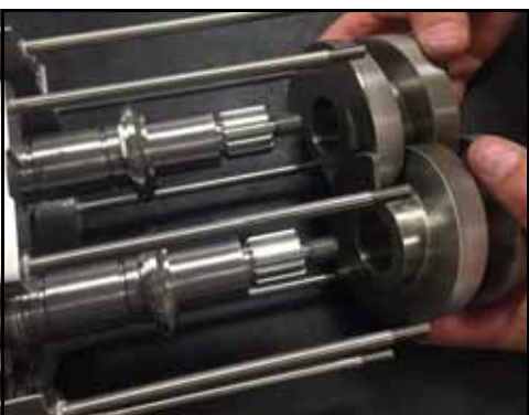
Figura 216 - Instalar os eixos
