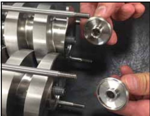
Figura 217 - Instalar as porcas dos fusos
