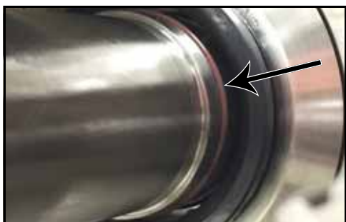
Figura 91 - Instalar o anel O-ring do eixo
