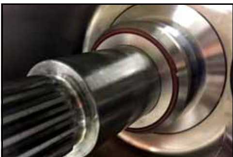
Figura 104 - Tampa de vedação instalada no eixo
