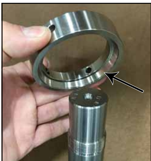
Figura 157 - Colocar o espaçador de rolamento no eixo
