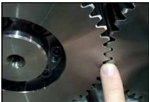
Figura 225 - Alinhar a engrenagem
