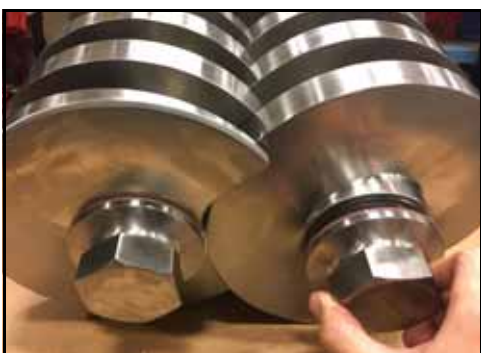
Figura 37 - Remover as porcas dos fusos
