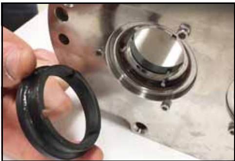
Figura 55 - Remover a vedação
