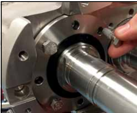
Figura 143 - Soltar e remover os parafusos do retentor de rolamento
