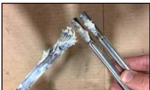
Figura 89 - Aplicar composto antigripante nas roscas
