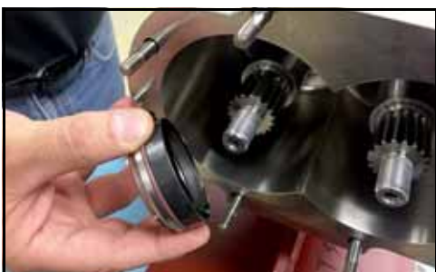
Figura 103 - Instalar o conjunto da tampa de vedação
