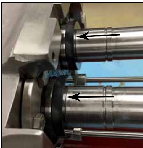
Figura 86 - Assentos de vedação instalados
