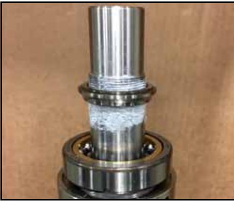
Figura 166 - Colocar a pista no eixo
