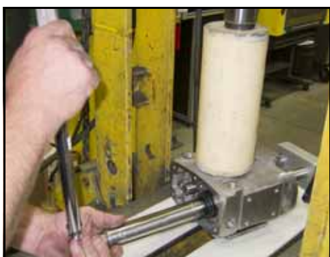
Figura 207 - Apertar a contraporca
