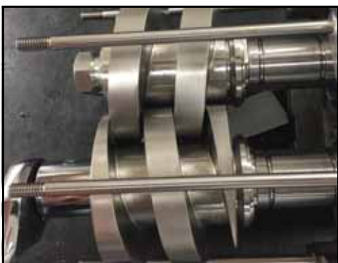
Figura 220 - Instalar as porcas dos fusos
