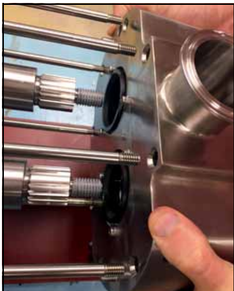
Figura 87 - Instalar a carcaça da bomba nos eixos
