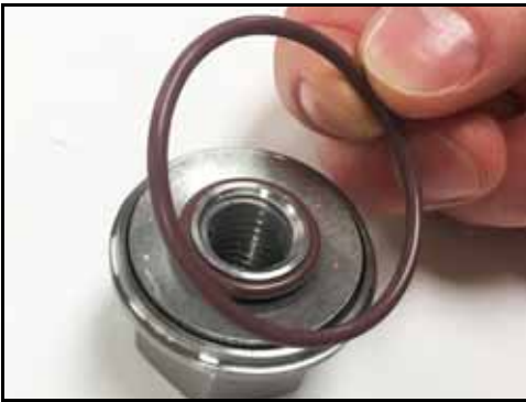
Figura 38 - Remover o anel O-ring da porca do fuso
