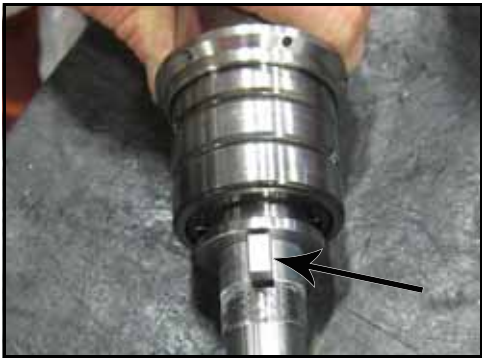
Figura 181 - Colocar a chaveta no rasgo do eixo
