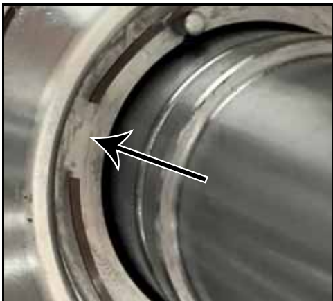
Figura 92 - Posição da mola ondulada da vedação
