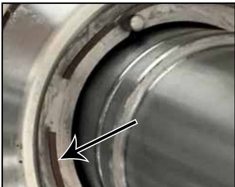
Figura 50 - Remover a mola ondulada da vedação
