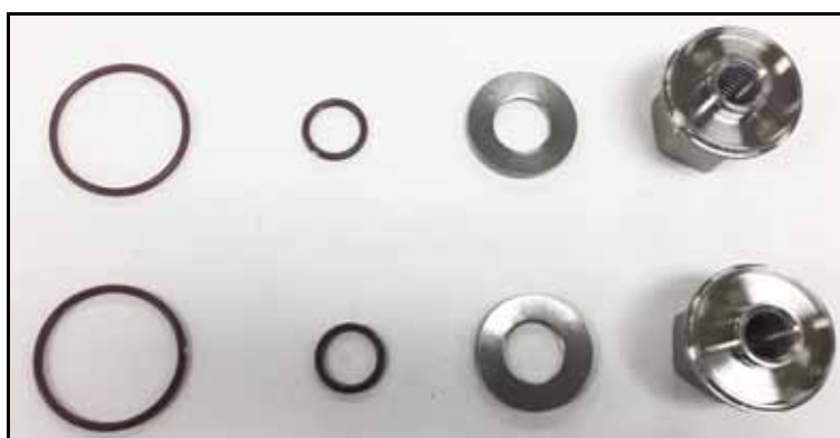
Figura 112 - Componentes da porca do fuso
