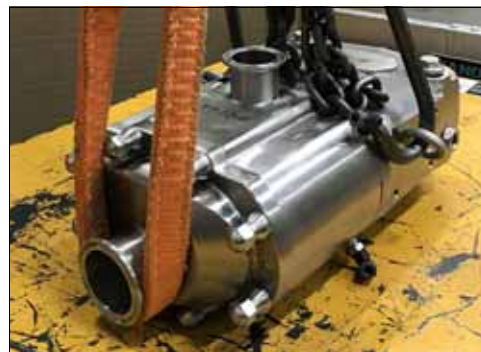
Figura 2 - Detalhe do local de elevação - 015, 030-UTS
