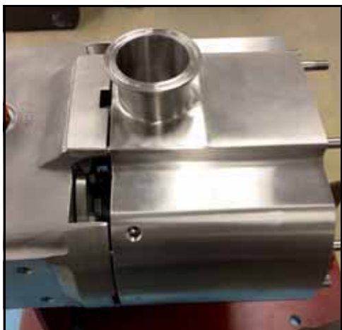
Figura 88 - Carcaça da bomba instalada
