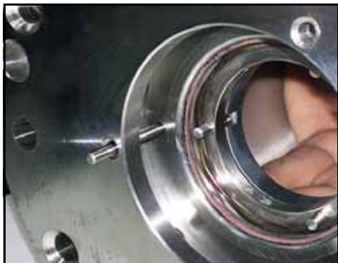
Figura 78 - Usar o pino de desvio para alinhar os orifícios
