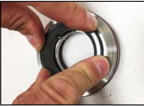
Figura 74 - Instalar a vedação
