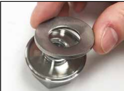
Figura 40 - Instalar a arruela Belleville
