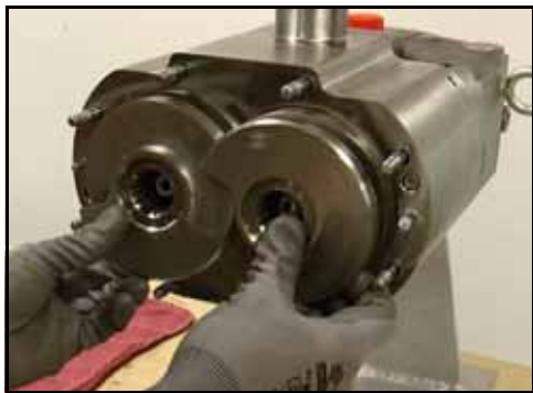
Figura 109 - Instalar os fusos
