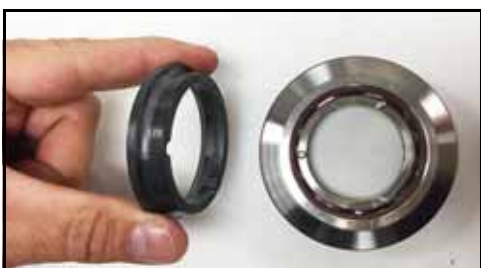
Figura 58 - Remover a vedação
