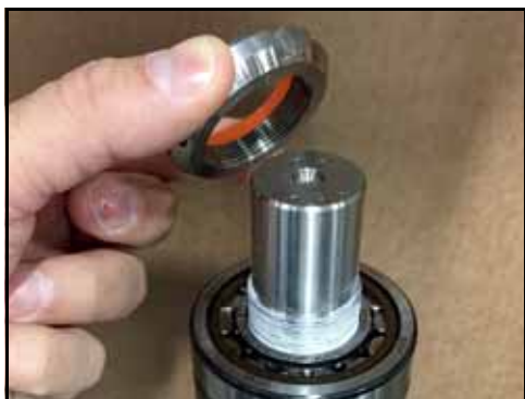
Figura 178 - Colocar a contraporca no eixo
