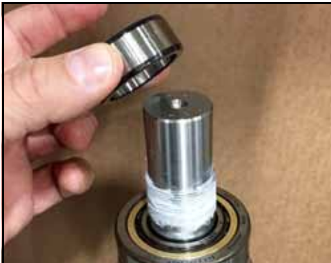
Figura 175 - Colocar a pista sobre o eixo
