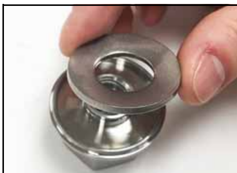
Figura 113 - Instalar a arruela Belleville
