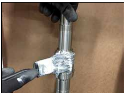
Figura 152 - Aplicar composto antigripante
