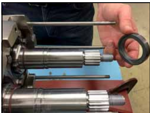
Figura 85 - Instalar os assentos de vedação
