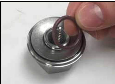
Figura 39 - Remover o anel O-ring do retentor da arruela
