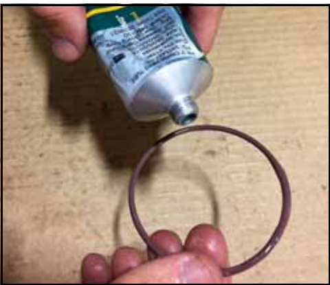
Figura 83 - Lubrificar os anéis O-ring
