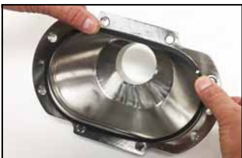
Figura 29 - Remover a junta da tampa
