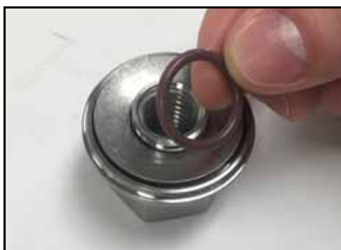
Figura 114 - Instalar o anel O-ring do retentor da arruela
