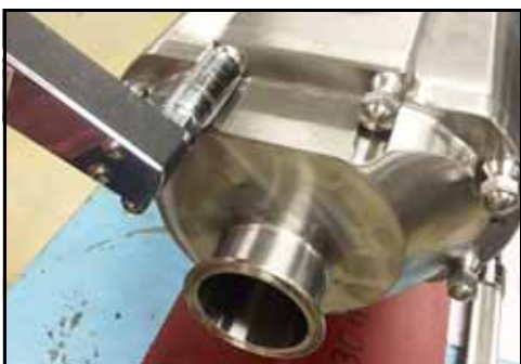
Figura 27 - Remover as porcas da tampa
