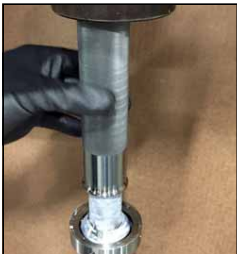
Figura 163 - Pressionar a pista contra o eixo
