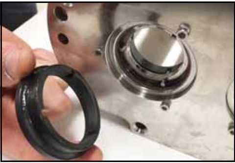
Figura 82 - Instalar a vedação
