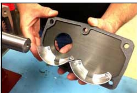
Figura 234 - Colocar a junta na tampa
