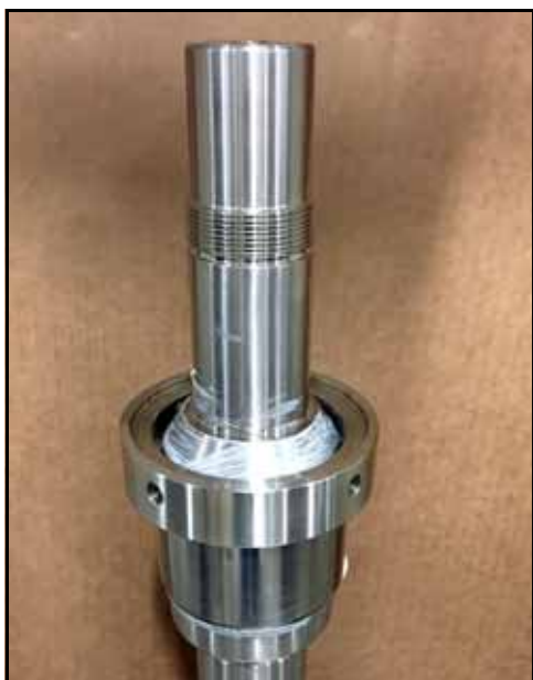
Figura 158 - Espaçador de rolamento instalado
