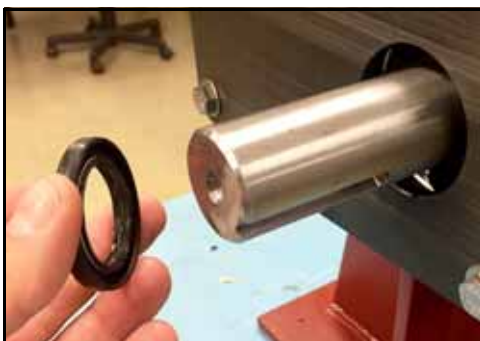
Figura 238 - Instalar a vedação de óleo
