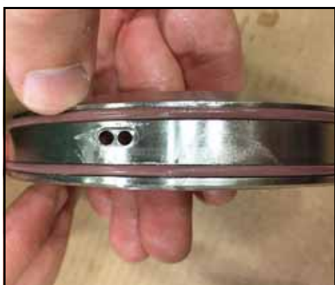
Figura 65 - Anéis O-ring instalados
