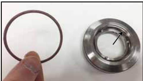
Figura 69 - Anel O-ring entre o suporte e a vedação
