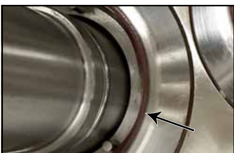
Figura 93 - Instalar o anel O-ring entre o suporte e a vedação
