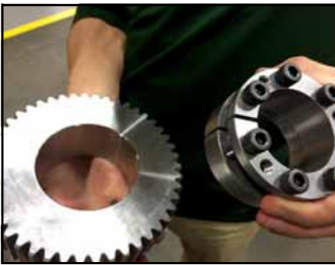
Figura 211 - Montar o conjunto de travamento na engrenagem
