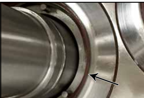
Figura 49 - Remover o anel O-ring entre o suporte e a vedação
