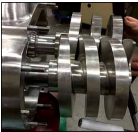
Figura 110 - Deslizar os fusos sobre os eixos
