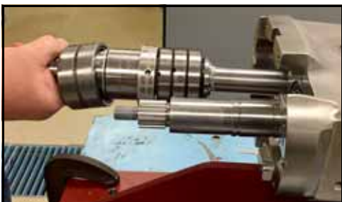
Figura 146 - Retirar o eixo de acionamento da caixa de engrenagem
