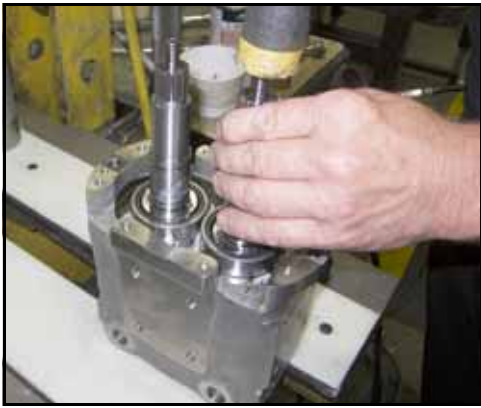
Figura 191 - Fixar os eixos no centro dos orifícios
